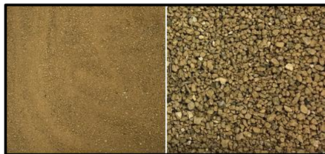
Figure 26 : Séparation de la fraction fine (gauche) et grossière (droite) d'un échantillon de sol
