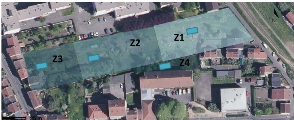
Zonage des sols homogènes du site de la MJC des 3 Maisons (MGN) et localisation des fosses pédologiques, Google Maps
