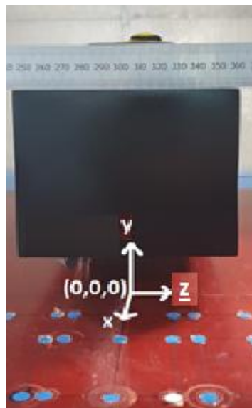
Figure 4. 7. Positionnement de l'origine du référentiel centré à l'arrière du corps d'Ahmed avec z=0 au niveau du plancher
