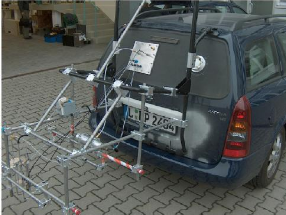
Figure 1. 6. Véhicule de test avec le système de capteurs fixés sur un porte-vélo à l'arrière
