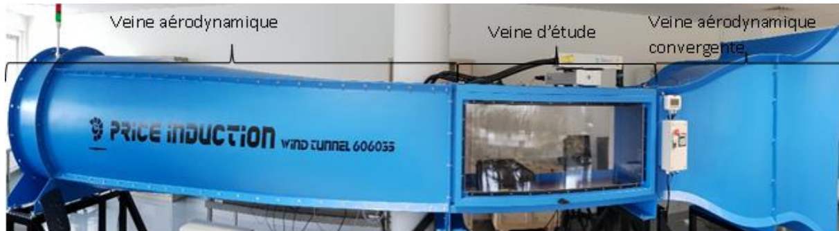
Figure 4. 6. Photographie de la soufflerie avec ses principaux éléments constitutifs
