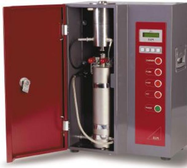
Figure 4. 17. Impacteur basse pression à détection électrique (ELPI)
