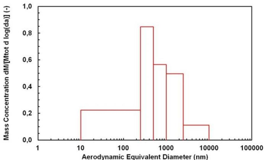
**Figure 23 : Diamètre aérodynamique médian en masse (DAMM) de l'aérosol nanostructuré de TiO<sub>2</sub> déterminé à l'aide de l'impacteur en cascade SIOUTAS.**
