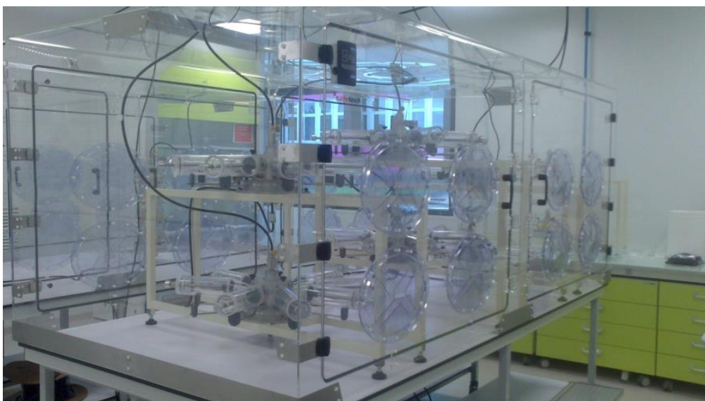
Figure 21: Description du système d'inhalation oro-nasale NanoTIREx.
