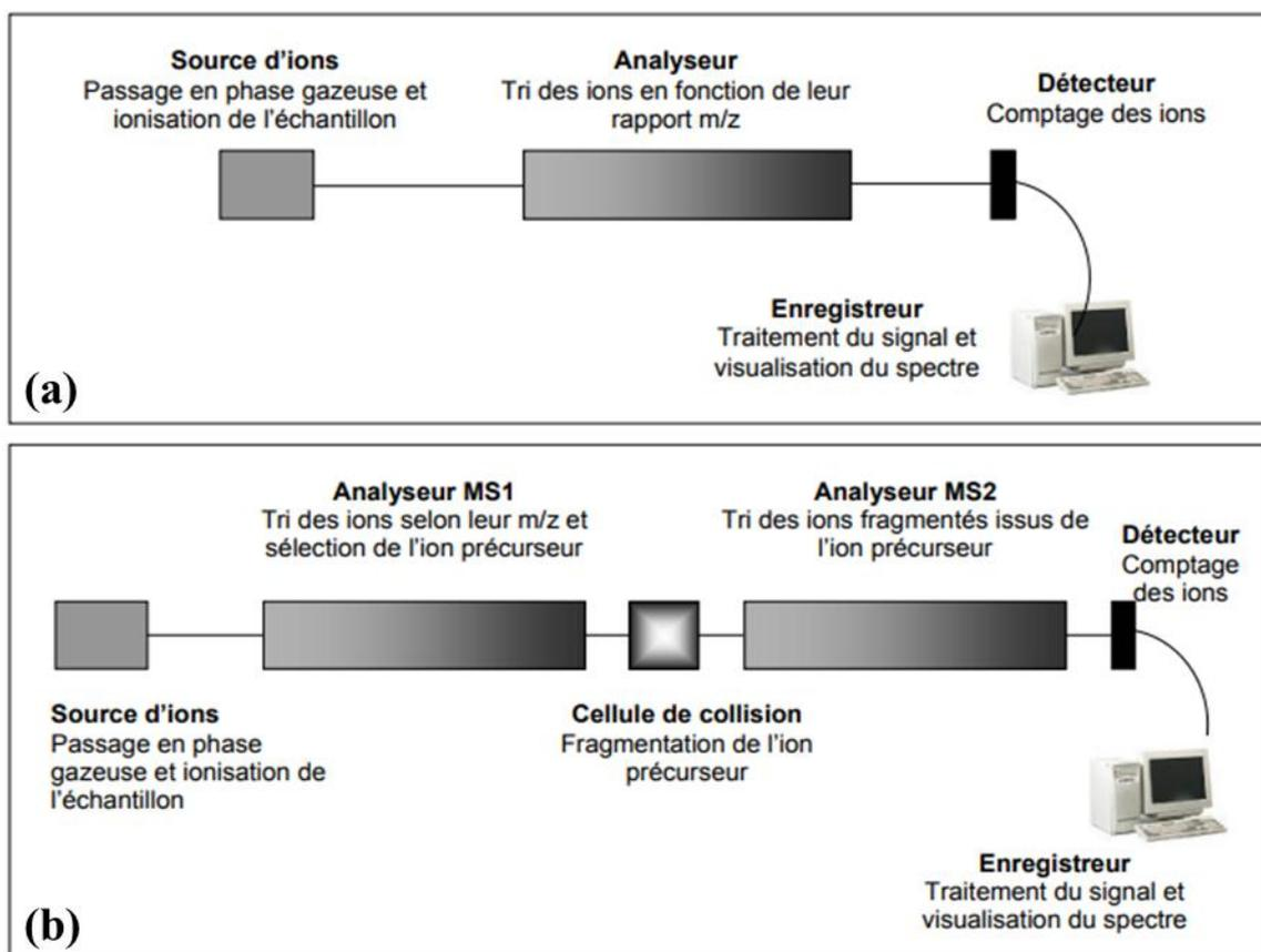
**Figure 19. Principe de la spectrométrie de masse (a) et de la spectrométrie de masse en tandem (b).**
