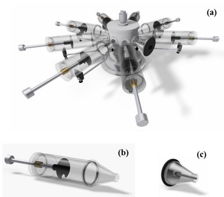
**Figure 22: Tour d'inhalation simple niveau (EMMS, Bordon, UK) (b) tubes de contention réalisés sur mesure (c) une sonde d'échantillonnage.**
