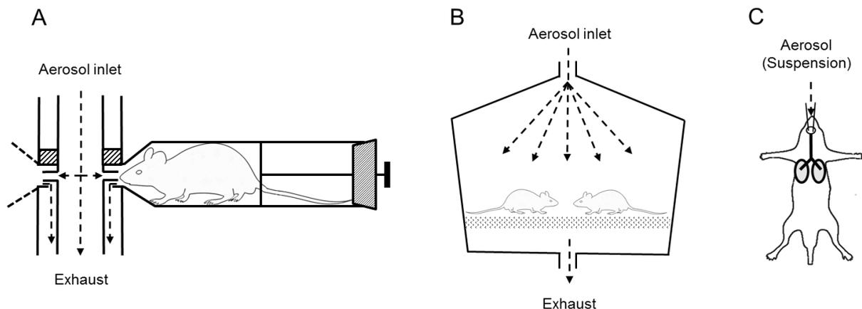
**Figure 10: Représentation schématique des modèles d'exposition par inhalation chez le rongeur.**
