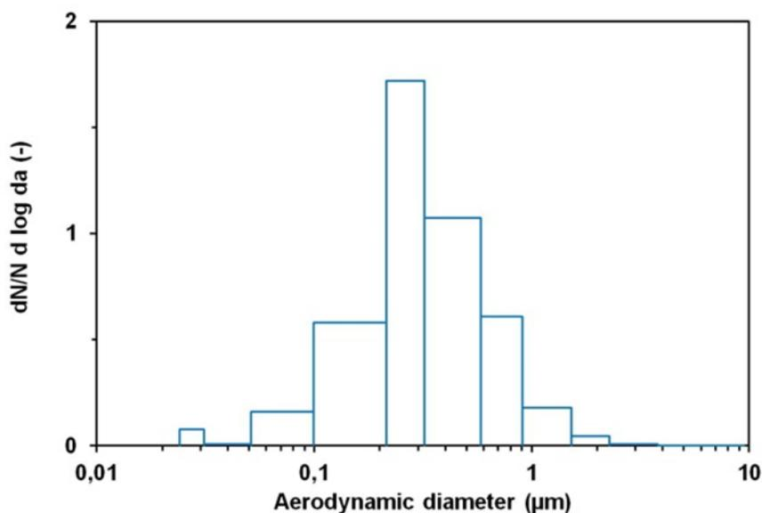
**Figure 24 : Diamètre aérodynamique médian en nombre (DAMN) de l'aérosol nanostructuré de TiO<sub>2</sub> déterminé à l'aide de l'impacteur basse pression de détection électrique ELPI.**
