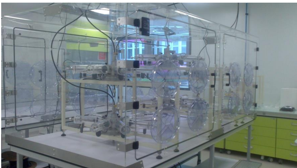
Figure 21: Description du système d'inhalation oro-nasale NanoTIREx.
