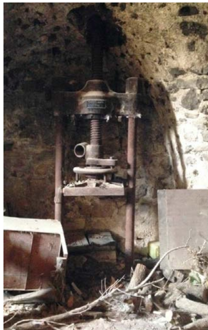
FIGURE 21 WAGNER BROS. PRESOIR À VIS À ACTIVATION MANUELLE (PVMF). (2014) [PHOTO]. MAISSOUN SHARKAWI 1143
