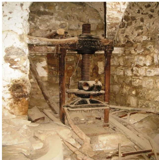
FIGURE 18 VILLAGE N° 16. BURHAM (2013) PRESOIR À VIS EN FER À ACTIVATION MANUELLE DE FABRICATION GRECQUE
