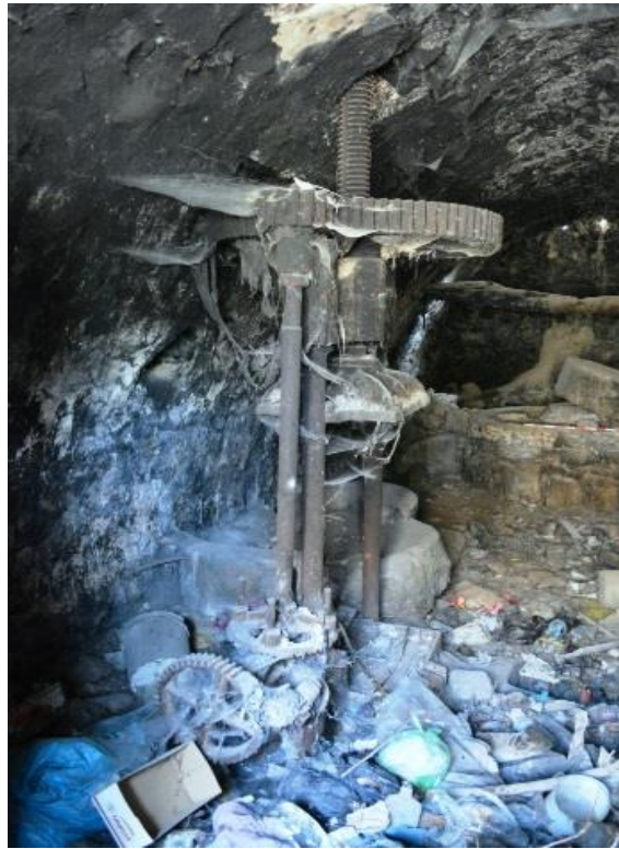
FIGURE 7 PRESSOIR À VIS EN FER À ACTIVATION MANUELLE AVEC TREUIL ADJACENT DU VILLAGE D'ABUSHKHEIDIM
