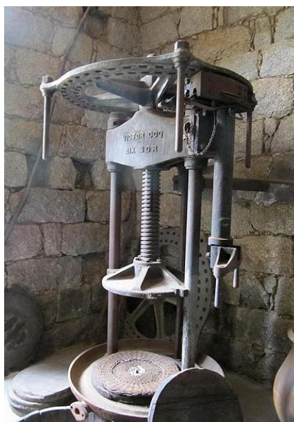
FIGURE 6 TREUIL ADJACENT D'UN PRESSEUR À HUILE D'OLIVE VICTOR COQ À SARTÈNE 1038
