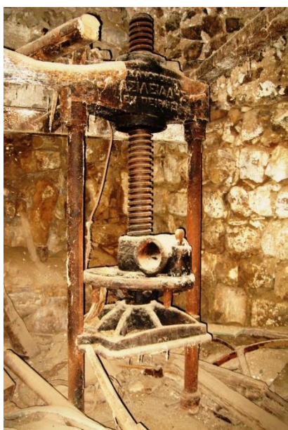
FIGURE 1, À GAUCHE PRESOIR À VIS EN FER À ACTIVATION MANUELLE AVEC LEVIER EN BOIS ET TREUIL LATÉRAL REPÉRÉ AU VILLAGE DE BURHAM .
