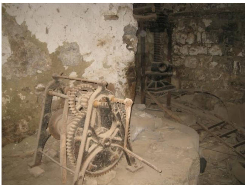
FIGURE 4 TREUIL LATÉRAL UTILISÉ POUR PVFM DE TYPE1 REPÉRÉ AU VILLAGE DE BURHAM
