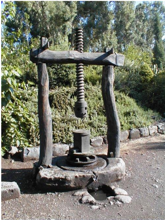
FIGURE 1, À GAUCHE RECONSTITUTION D'UN PRESSEUR À VIS EN BOIS À PRESSION DIRECTE. [PHOTOGRAPHE]. GALILÉE 557 .
