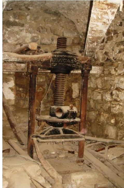
FIGURE 2, À DROITE PRESSEUR À VIS EN FER À PRESSION DIRECTE BADD AL-'AROURI, BURHAM 558
