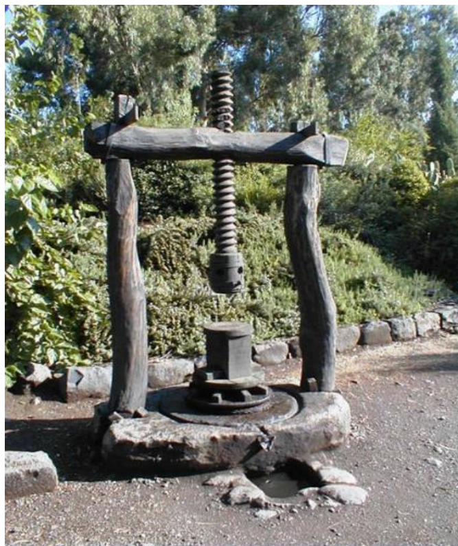
FIGURE 29 RECONSTITUTION D'UN PRESOIR À CADRE RIGIDE À PRESSION DIRECTE. [PHOTOGRAPH]. GALILÉE 517 .
