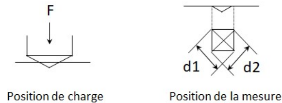
Figure 60: Principe de l'essai de microdureté Vickers
