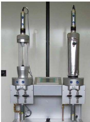
Figure 37: Distributeur de poudre « DUO Spécial » de Medicoat AG [Source : guide utilisateur Medicoat AG]
