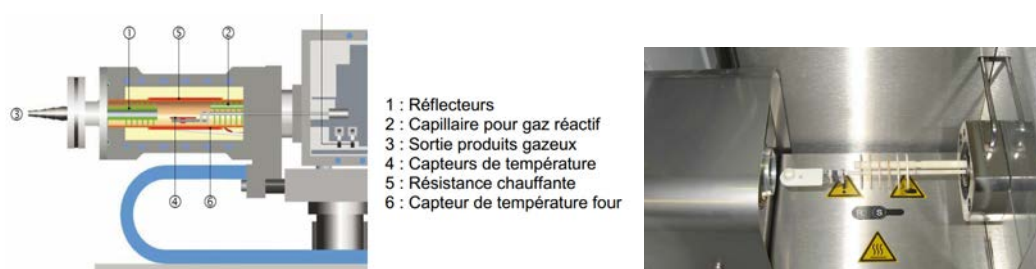
FIGURE 1.12 – Principe de fonctionnement d'un analyseur thermogravimétrique et vue du four - Source Mettler-Toledo
