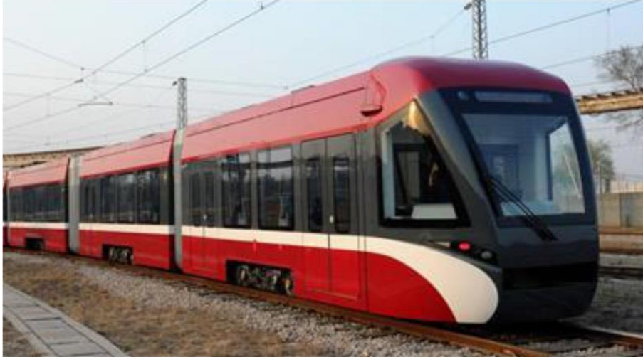
Figure I-36 : Tramway hybride chinois circulant à Samsun en Turquie. Conçut par la société chinoise Tangshan Railway Vehicule, il est alimenté par une pile à combustible couplée à des batteries [222, 223].
