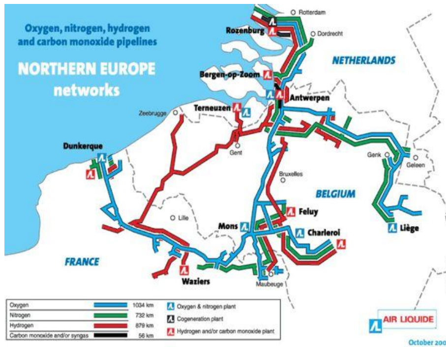
Figure I-35 : Les différents réseaux de distribution en gaz gérés par Air Liquide en Europe du Nord [217].
