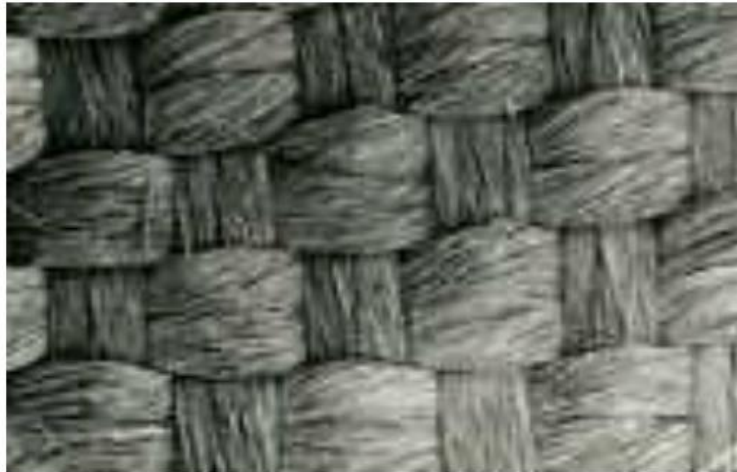
Figure I-43 : Structure d'un tissu de carbone activé observé au microscope électronique [227].
