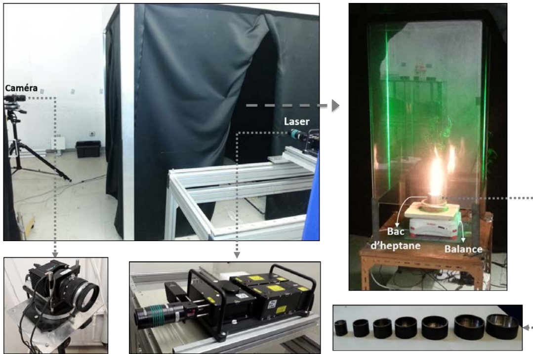
FIGURE 3.2 – Dispositif expérimental utilisé pour étudier le phénomène de remplissage.
