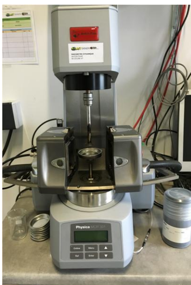
Figure 61 : Rhéomètre utilisé pour la détermination de viscosité
