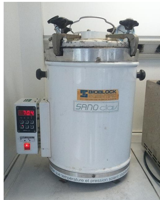
Figure 59 : Dispositif de vieillissement utilisé
