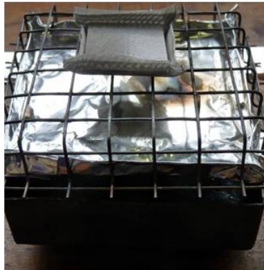
Figure 65 : Montage avec la toile d'Inconel® posée sur grille
