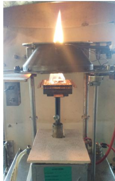
Figure 65 : Montage avec la toile d'Inconel® posée sur grille
