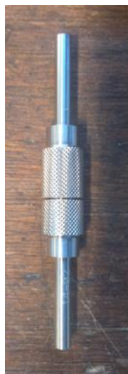
Figure 67 : MPS utilisé pour le prélèvement des suies
