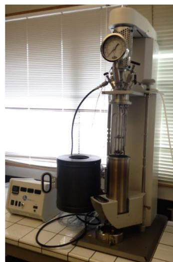
Figure 19. Réacteur Parr utilisé pour le traitement organosolv
