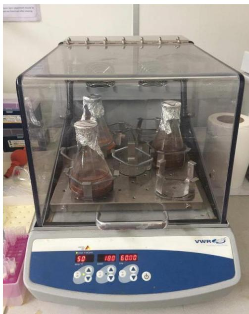
Figure 23. Dispositif d'hydrolyse enzymatique
