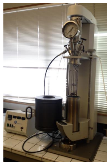
Figure 19. Réacteur Parr utilisé pour le traitement organosolv
