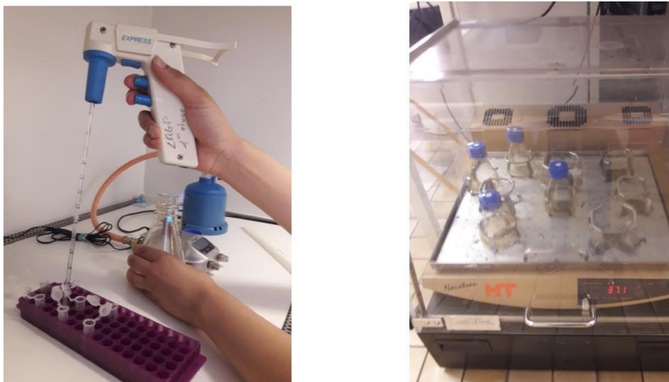
Figure 25. Dispositif de fermentation et prélèvement sous PSM
