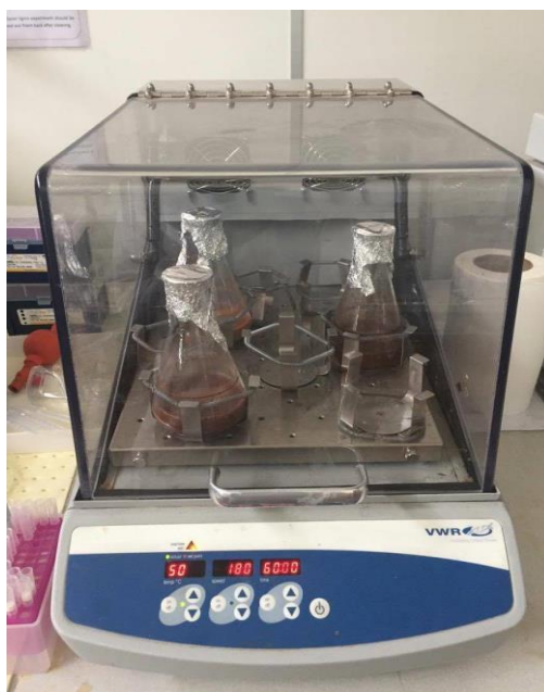
Figure 23. Dispositif d'hydrolyse enzymatique
