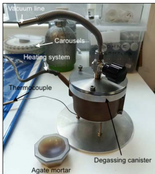
Fig. 2-8 – Photographie du système de dégazage sous vide utilisé pour la déshydratation des échantillons.
