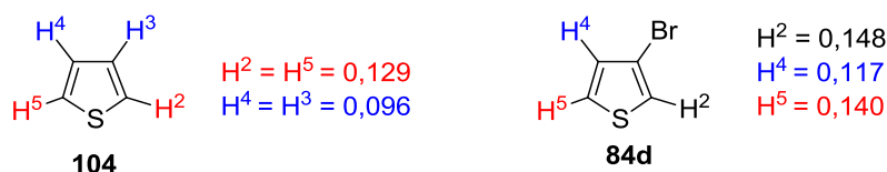
Figure 4.2 : Comparaison des charges de Mulliken calculées pour le thiophène et le 3-bromothiophène
