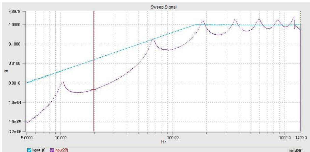
Figure III.4 : Signal de l'excitation et réponse en amplitude
