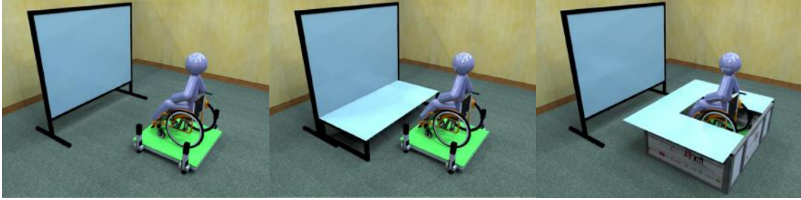
FIGURE 1.12 – Différentes configurations de visualisation : Face, WorkBench et Jupe [12]
