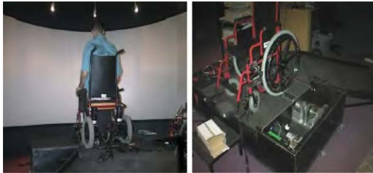
FIGURE 1.35 – Plateforme de simulation pour un fauteuil roulant manuel et électrique[18]
