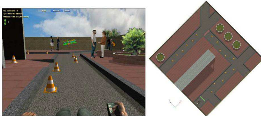
FIGURE 1.38 – Simulateur de conduite ViEW : vue embarquée 3D (à gauche) et vue externe 2D (à droite)
