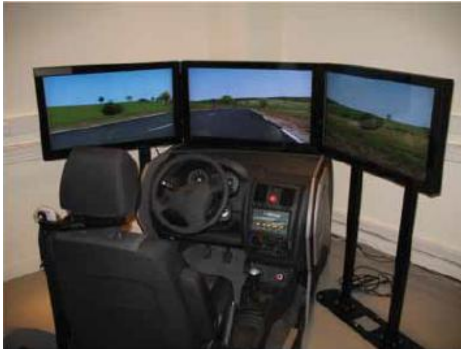
FIGURE 2.18 – Simulateur de conduite à base fixe [30]
