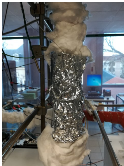
Figure 33 : Le réacteur équipé de son système de calorifugeage
