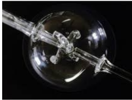
Figure 31 : Réacteur auto-agité par jets gazeux utilisé au LRGP
