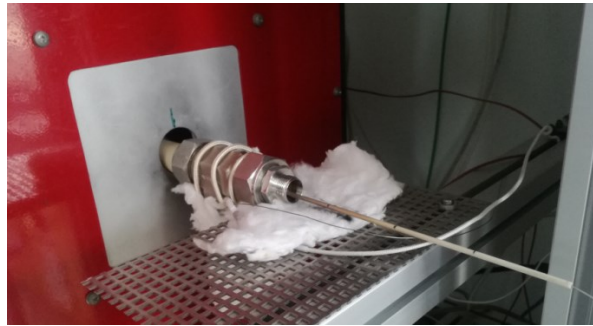
Figure 36 : Mesure des profils de température au sein du réacteur
