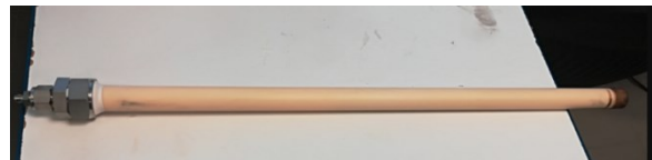
Figure 34 : Réacteur tubulaire en alumine utilisé dans le cadre de cette thèse
