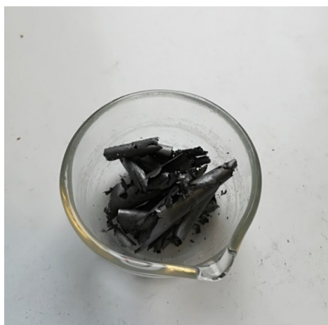
Figure 90 : dépôt solide retiré des parois du réacteur après décokage à l'oxygène à 1200 K
