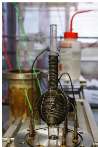
Figure 32 : Un réacteur équipé de son système de chauffage
