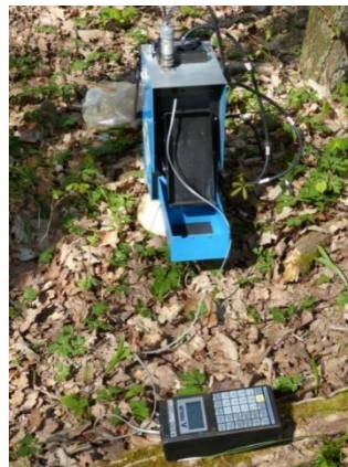
Figure IV.8. Photographie du dispositif de suivi de teneur en eau du sol. Crédit photo : J. Levillain.
