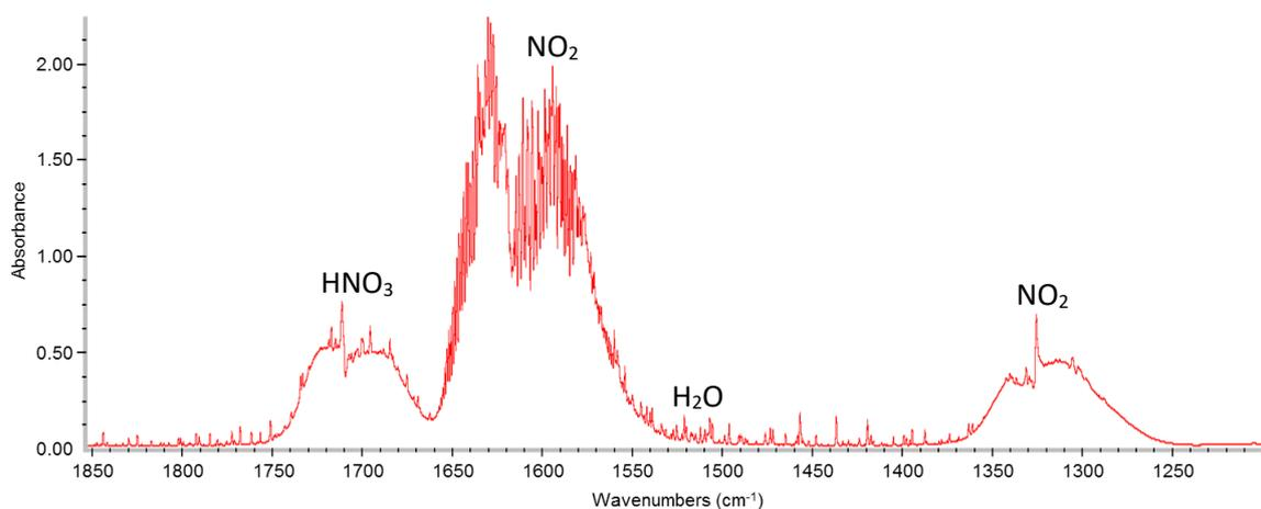
Figure 4.1 : Spectre FTIR montrant les pics caractéristiques de HNO<sub>3</sub>, NO<sub>2</sub> et H<sub>2</sub>O pendant la désorption de Na Y (spectre à 280°C)
