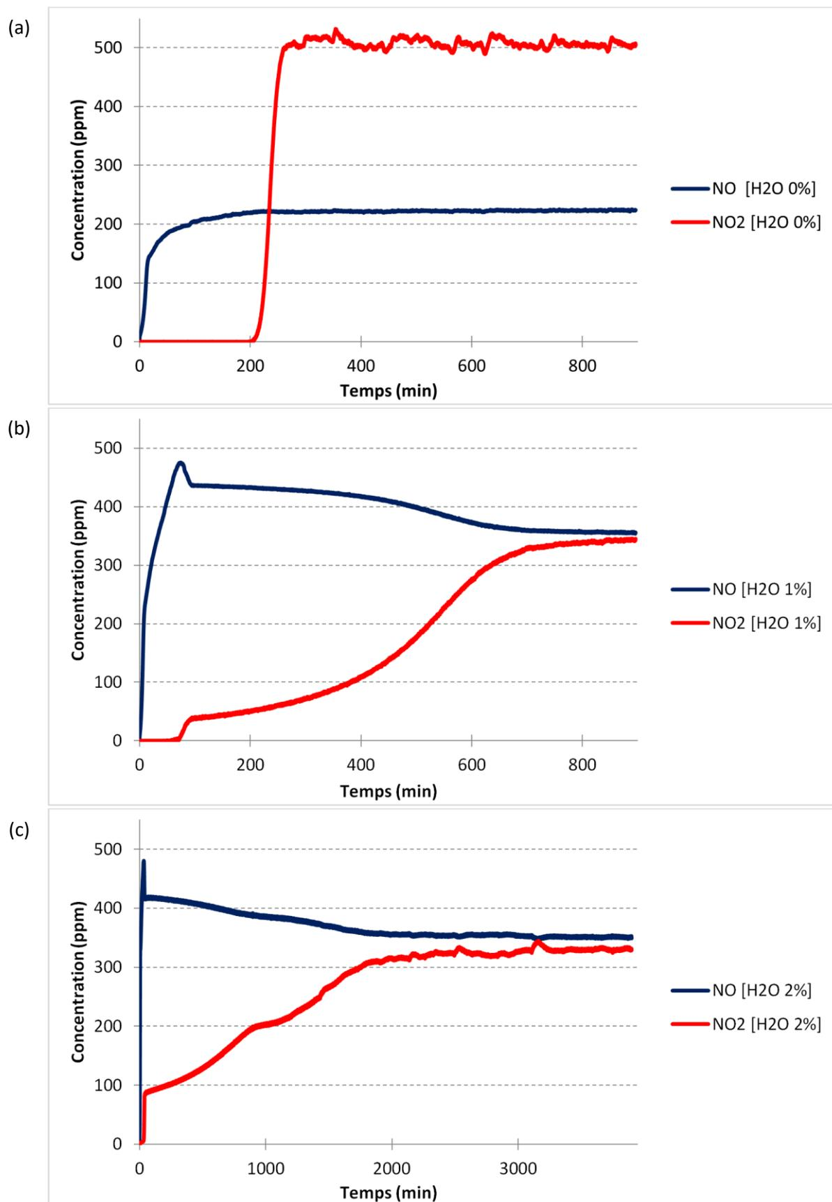
Graphe 4.22 : Concentrations de sortie de NO et NO<sub>2</sub> au cours de l'adsorption à 30°C de 350 ppm de NO, 350 ppm de NO<sub>2</sub> et 8,5 % d'O<sub>2</sub> dilués dans N<sub>2</sub> sur la zéolithe Na Y 2,55 séchée avec 0 % (a), 1 % (b) et 2 % (c) de vapeur d'eau dans le mélange gazeux
