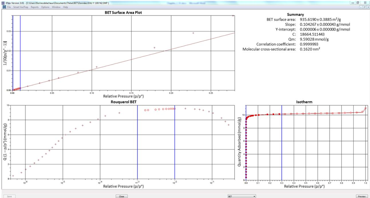
Figure 2.1 : Graphes obtenus suite à la détermination de l'isotherme d'adsorption de N<sub>2</sub> à 77 K sur la zéolithe Na Y 2,55
