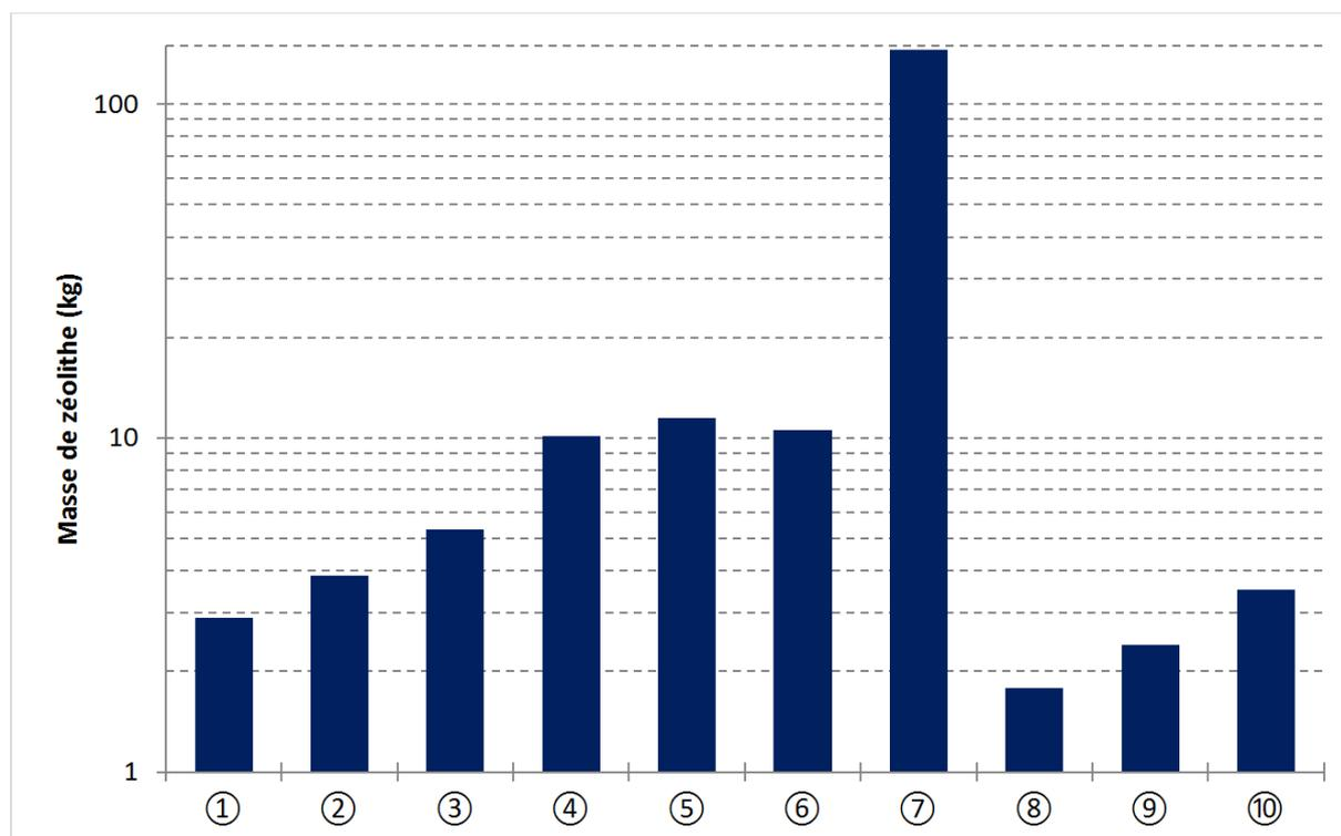
Graph 4.36 : Masses de zéolithe Na Y 2,55 à utiliser pour retenir NO<sub>2</sub> présent dans les gaz d'échappement diesel d'un véhicule non routier de 19 kW de puissance pendant huit heures (les numéros correspondent aux expériences indiquées dans le tableau 4.8)
