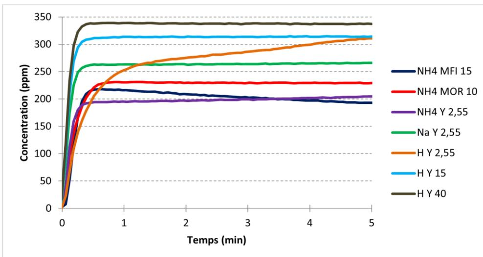
Graphe 3.13 : Fronts de percée de NO au cours de l’adsorption à 30°C de 350 ppm de NO et 8,5 % d’O<sub>2</sub> dilués dans N<sub>2</sub>
