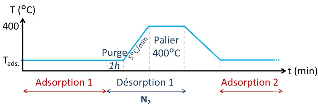
Figure 2.5 : Schéma des cycles d'adsorption et de désorption
