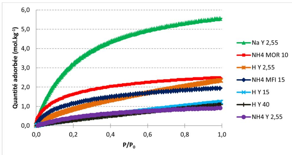
Graph 3.7 : Isothermes d'adsorption de CO<sub>2</sub> à 30°C
