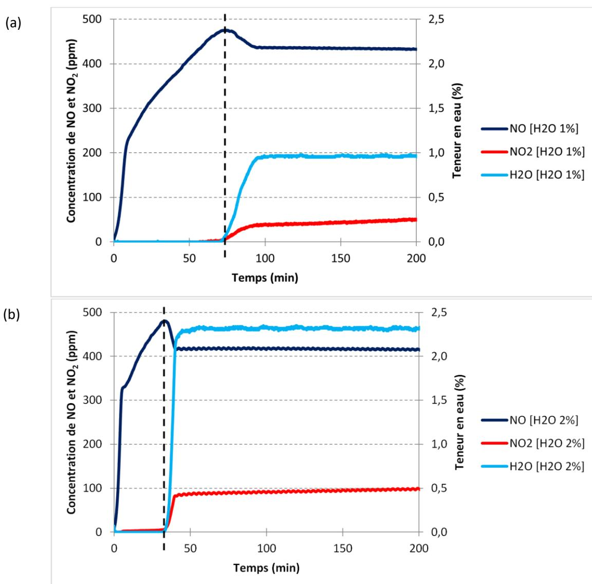
Graphe 4.23 : Concentrations de sortie de NO, NO<sub>2</sub> et H<sub>2</sub>O au cours de l'adsorption à 30°C de 350 ppm de NO, 350 ppm de NO<sub>2</sub> et 8,5 % d'O<sub>2</sub> dilués dans N<sub>2</sub> sur la zéolithe Na Y 2,55 séchée avec 1 % (a) et 2 % (b) de vapeur d'eau dans le mélange gazeux – zoom du graphe 4.22
