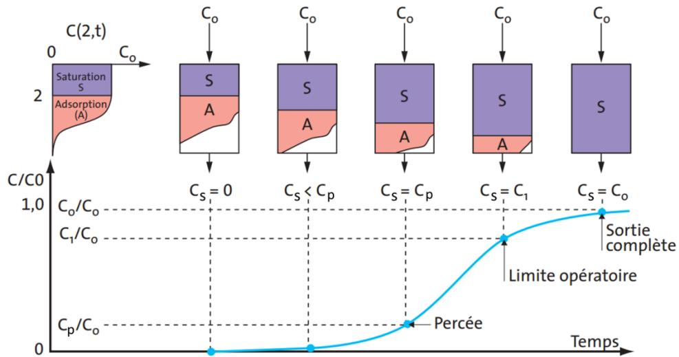
Figure 2.6 : Principe d'un front de percée [40]
