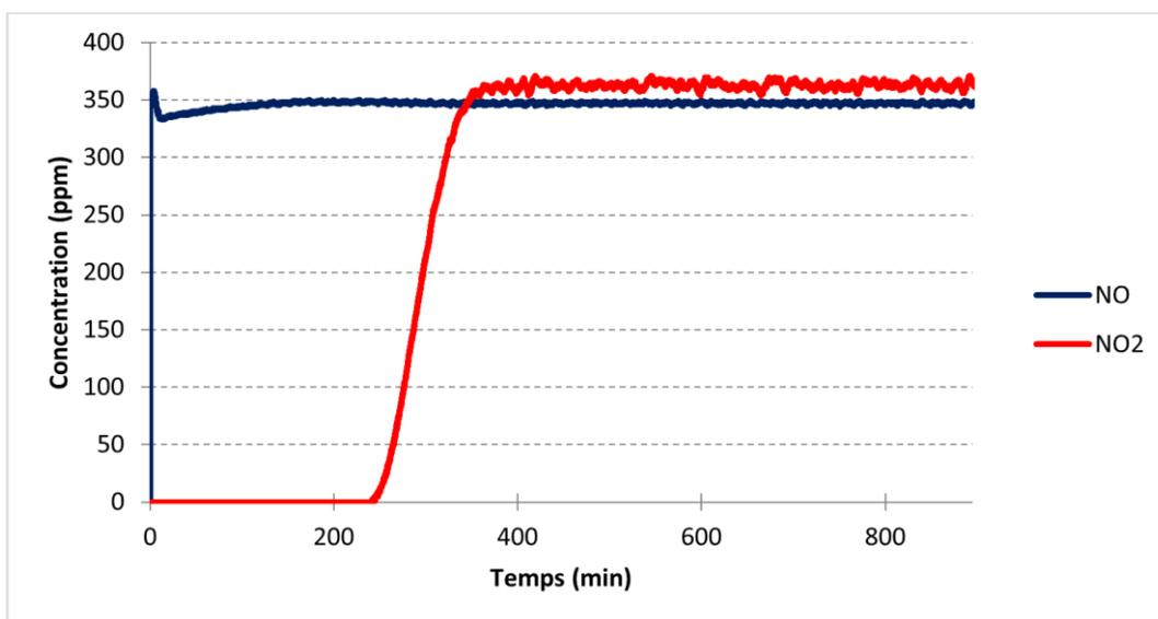
Graphe 4.10 : Concentrations de sortie de NO et NO<sub>2</sub> au cours de l'adsorption à 30°C de 350 ppm de NO et 350 ppm de NO<sub>2</sub> dilués dans N<sub>2</sub> sur la zéolithe Na Y 2,55 séchée
