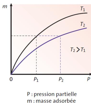
Figure 1.5 : Schématisation d'isothermes d'adsorption à deux températures [40]
