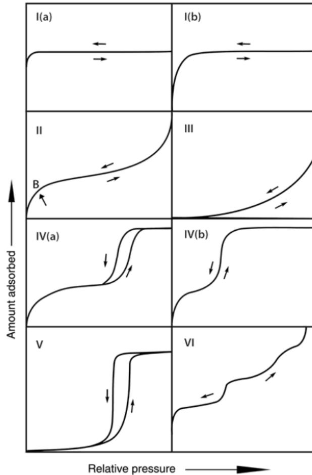
Figure 1.4 : Classification des isothermes d'adsorption
