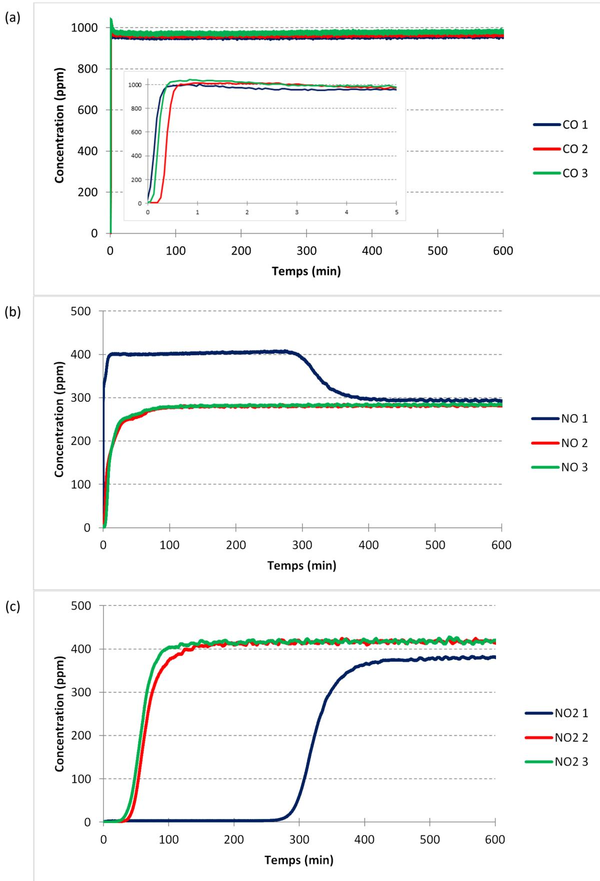
Graphe 4.2 : Fronts de percée au cours de l'adsorption à 30°C de 350 ppm de NO, 350 ppm de NO<sub>2</sub>, 1000 ppm de CO et 8,5 % d'O<sub>2</sub> dilués dans N<sub>2</sub> sur la zéolithe NH<sub>4</sub> Y 2,55 : CO (a), NO (b) et NO<sub>2</sub> (c)
