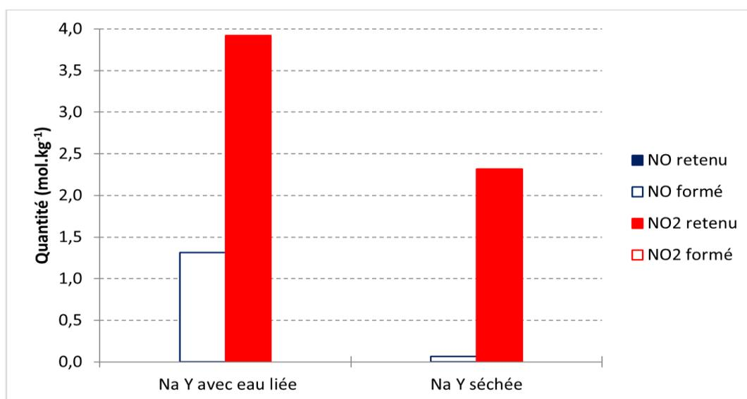
Graphe 4.16 : Quantités retenues et formées à  $t = 900 \text{ min}$  de  $\text{NO}$  et  $\text{NO}_2$  en fonction de la présence d'eau liée dans la zéolithe Na Y 2,55 lors de l'adsorption à  $30^\circ\text{C}$  de  $350 \text{ ppm}$  de  $\text{NO}_2$  dilués dans  $\text{N}_2$  (graphe 4.15 et graphe 4.7)
