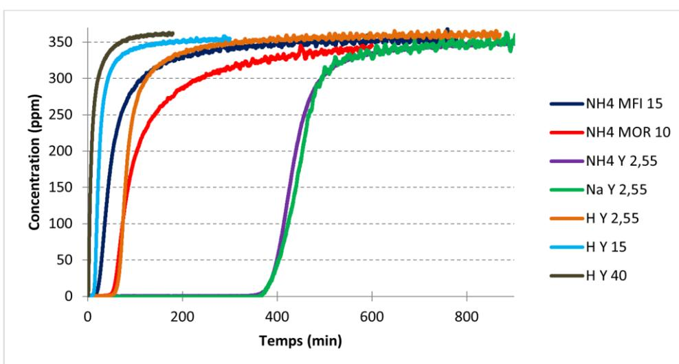
Graphe 3.14 : Fronts de percée de NO<sub>2</sub> au cours de l’adsorption à 30°C de 350 ppm de NO<sub>2</sub> et 8,5 % d’O<sub>2</sub> dilués dans N<sub>2</sub>
