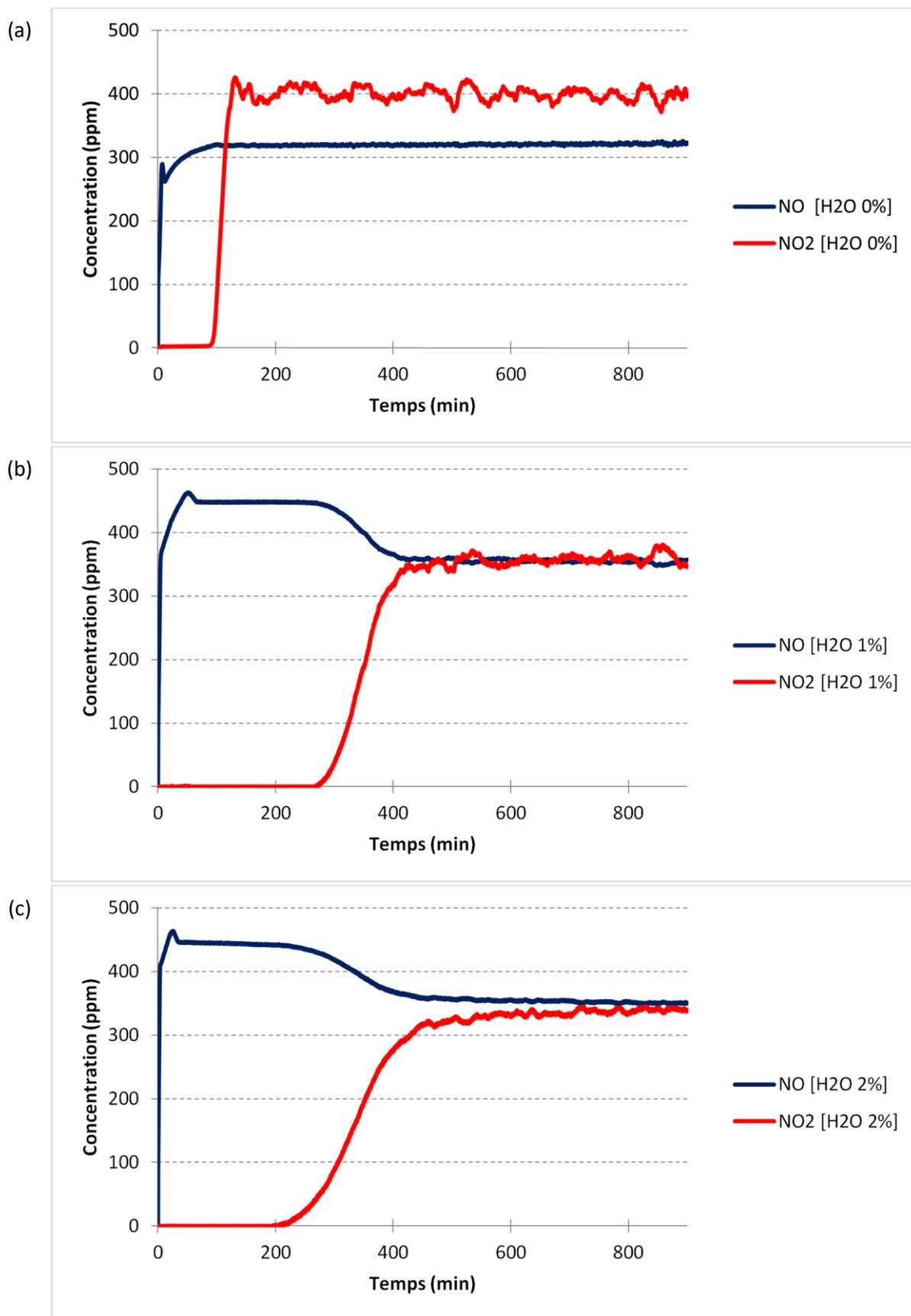
Graphe 4.28 : Concentrations de sortie de NO et NO<sub>2</sub> au cours de l'adsorption à 60°C de 350 ppm de NO, 350 ppm de NO<sub>2</sub> et 8,5 % d'O<sub>2</sub> dilués dans N<sub>2</sub> sur la zéolithe Na Y 2,55 séchée avec 0 % (a), 1 % (b) et 2 % (c) de vapeur d'eau dans le mélange gazeux
