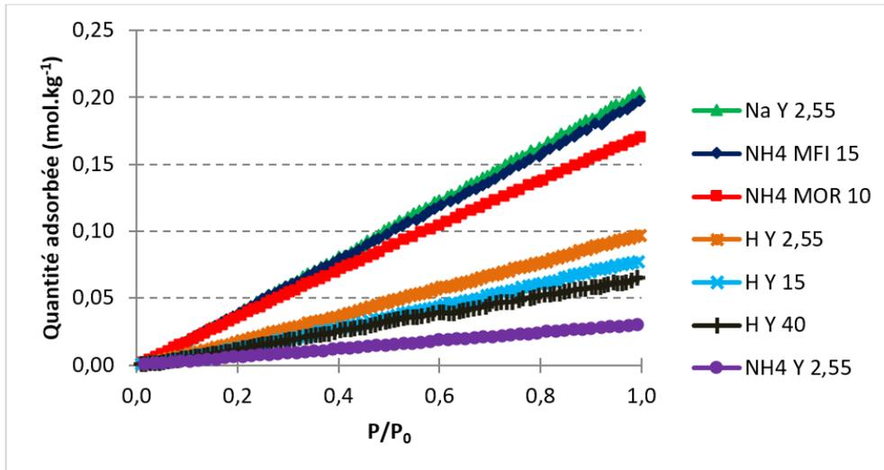
Graph 3.2 : Isothermes d'adsorption de N<sub>2</sub> à 30°C
