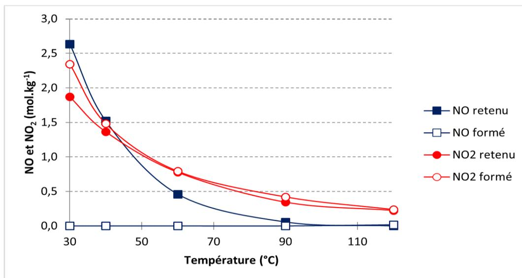
Graphique 4.27 : Quantités à t = 900 min de NO, NO<sub>2</sub> et H<sub>2</sub>O retenues et/ou formées en fonction de la teneur en eau lors de l'adsorption à différentes températures de 350 ppm de NO, 350 ppm de NO<sub>2</sub> et 8,5 % d'O<sub>2</sub> dilués dans N<sub>2</sub> sur la zéolithe Na Y 2,55 séchée
