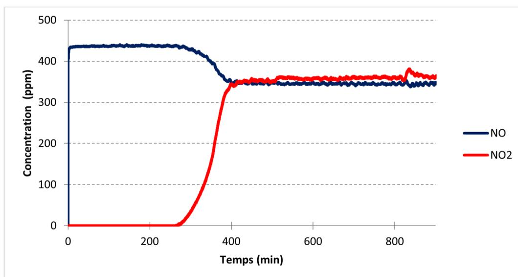
Graphe 4.17 : Concentrations de sortie de NO et NO<sub>2</sub> au cours de l'adsorption à 30°C de 350 ppm de NO et de 350 ppm de NO<sub>2</sub> dilués dans N<sub>2</sub> sur la zéolithe Na Y 2,55
