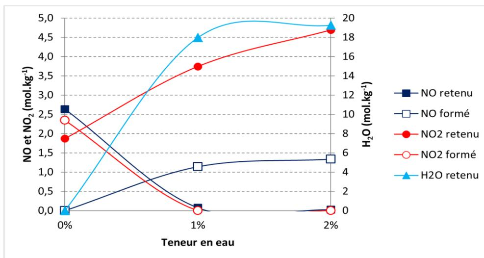
Graph 4.24 : Quantités à  $t = 900$  min de NO, NO<sub>2</sub> et H<sub>2</sub>O retenues et/ou formées en fonction de la teneur en eau lors de l'adsorption à 30°C de 350 ppm de NO, 350 ppm de NO<sub>2</sub> et 8,5 % d'O<sub>2</sub> dilués dans N<sub>2</sub> sur la zéolithe Na Y 2,55 séchée
