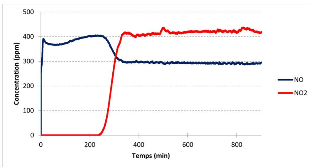
Graphe 4.19 : Concentrations de sortie de NO et NO<sub>2</sub> au cours de l'adsorption à 30°C de 350 ppm de NO, 350 ppm de NO<sub>2</sub> et 8,5 % d'O<sub>2</sub> dilués dans N<sub>2</sub> sur la zéolithe Na Y 2,55
