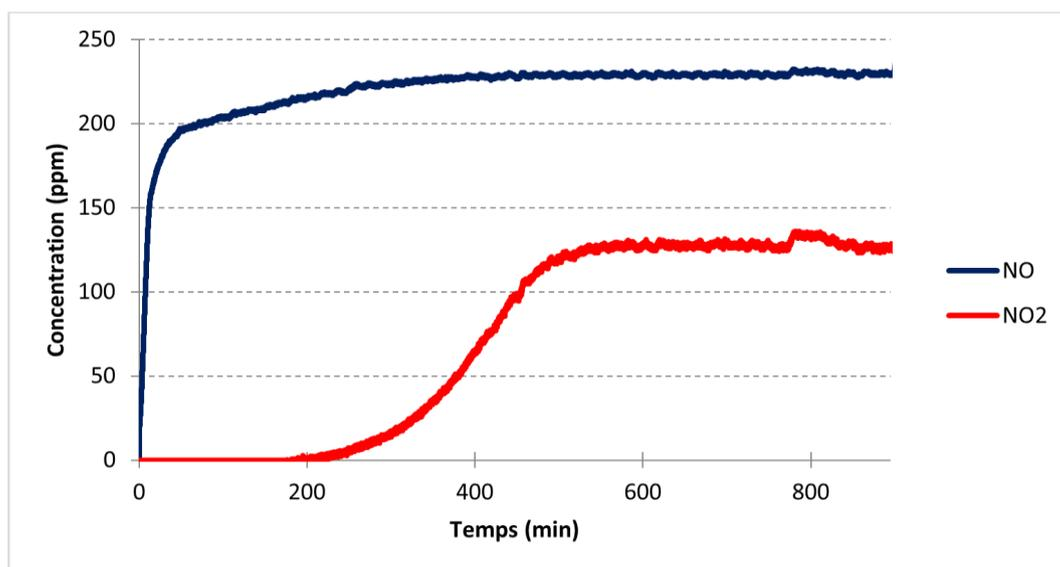
Graph 4.6 : Concentrations de sortie de NO et NO<sub>2</sub> au cours de l'adsorption à 30°C de 350 ppm de NO et 8,5 % d'O<sub>2</sub> dilués dans N<sub>2</sub> sur la zéolithe Na Y 2,55 séchée
