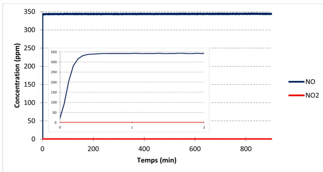
Graphe 4.14 : Concentrations de sortie de NO et NO<sub>2</sub> au cours de l'adsorption à 30°C de 350 ppm de NO dilués dans N<sub>2</sub> sur la zéolithe Na Y 2,55 - le graphe intérieur est un zoom sur les deux premières minutes
