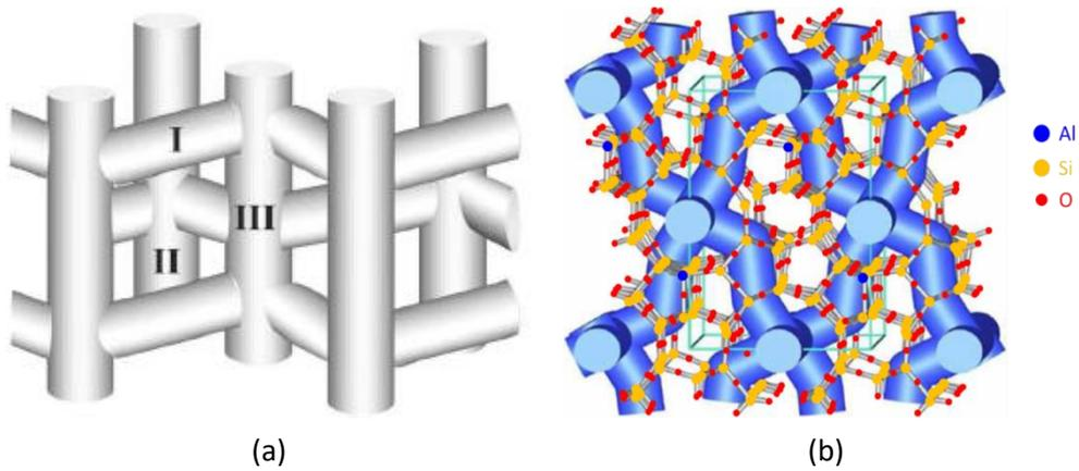
Figure 1.13 : Schéma simplifié de la structure d'une zéolithe MFI : vue de profil (a) – I : canal sinusoïdal ; II : canal droit ; III : intersection – et vue de dessus (b) [61, 97, 98]
