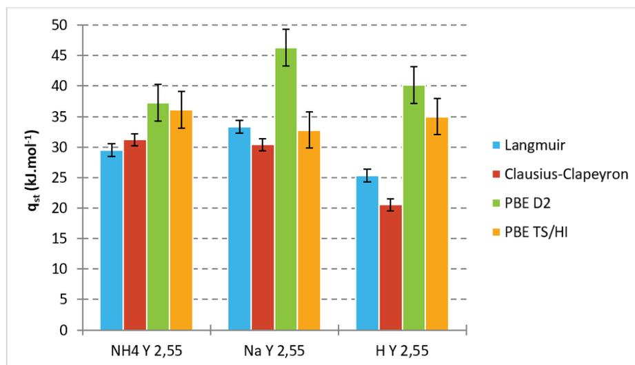
Grappe 3.11 : Comparaison des chaleurs isostériques d'adsorption de CO<sub>2</sub> à 50°C obtenues expérimentalement ou par DFT
