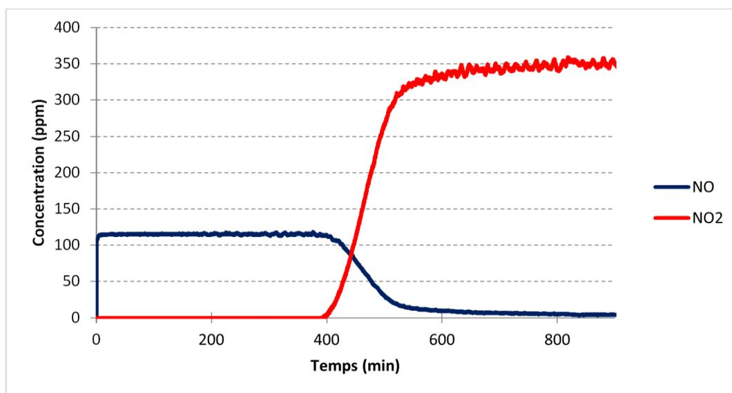
Graphe 4.15 : Concentrations de sortie de NO et NO<sub>2</sub> au cours de l'adsorption à 30°C de 350 ppm de NO<sub>2</sub> dilués dans N<sub>2</sub> sur la zéolithe Na Y 2,55
