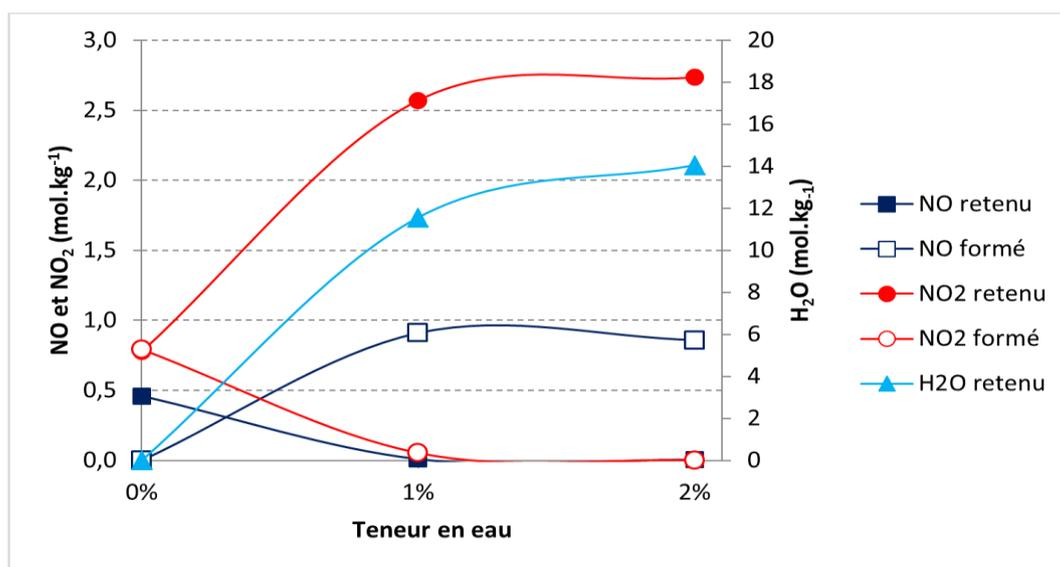
Graphe 4.30 : Quantités à t = 900 min de NO, NO<sub>2</sub> et H<sub>2</sub>O retenues et/ou formées en fonction de la teneur en eau lors de l'adsorption à 60°C de 350 ppm de NO, 350 ppm de NO<sub>2</sub> et 8,5 % d'O<sub>2</sub> dilués dans N<sub>2</sub> sur la zéolithe Na Y 2,55 séchée
