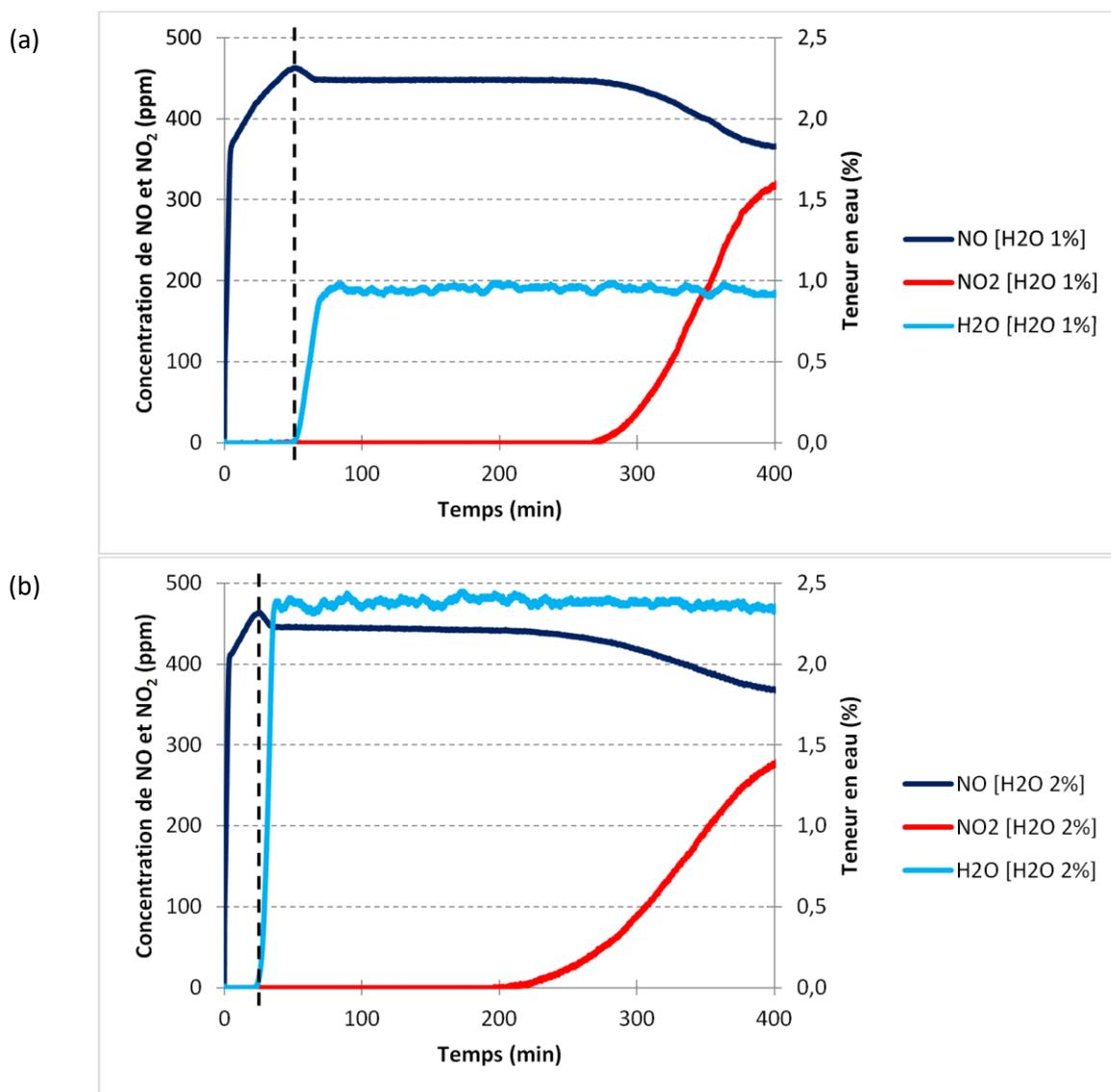
Graphe 4.29 : Concentrations de sortie de NO, NO<sub>2</sub> et H<sub>2</sub>O au cours de l'adsorption à 60°C de 350 ppm de NO, 350 ppm de NO<sub>2</sub> et 8,5 % d'O<sub>2</sub> dilués dans N<sub>2</sub> sur la zéolithe Na Y 2,55 séchée avec 1 % (a) et 2 % (b) de vapeur d'eau dans le mélange gazeux – zoom du graphe 4.28
