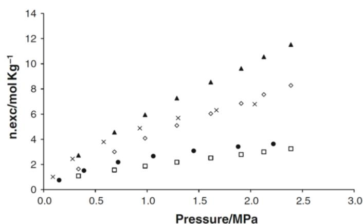
Figure 1.6 : Isothermes d'adsorption des corps purs CO<sub>2</sub> et CH<sub>4</sub> et du mélange équimolaire CO<sub>2</sub> / CH<sub>4</sub> à 30°C [41]
