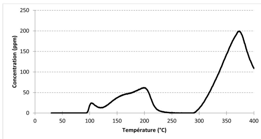
Grappe 4.3 : Concentration de sortie de  $\text{NH}_3$  au cours de la désorption à  $5^\circ\text{C}\cdot\text{min}^{-1}$  de  $30$  à  $400^\circ\text{C}$  de la zéolithe  $\text{NH}_4\text{Y}$  2,55 suite à l'adsorption à  $30^\circ\text{C}$  de  $350$  ppm de  $\text{NO}$ ,  $350$  ppm de  $\text{NO}_2$ ,  $1000$  ppm de  $\text{CO}$  et  $8,5\%$  d' $\text{O}_2$  dans  $\text{N}_2$
