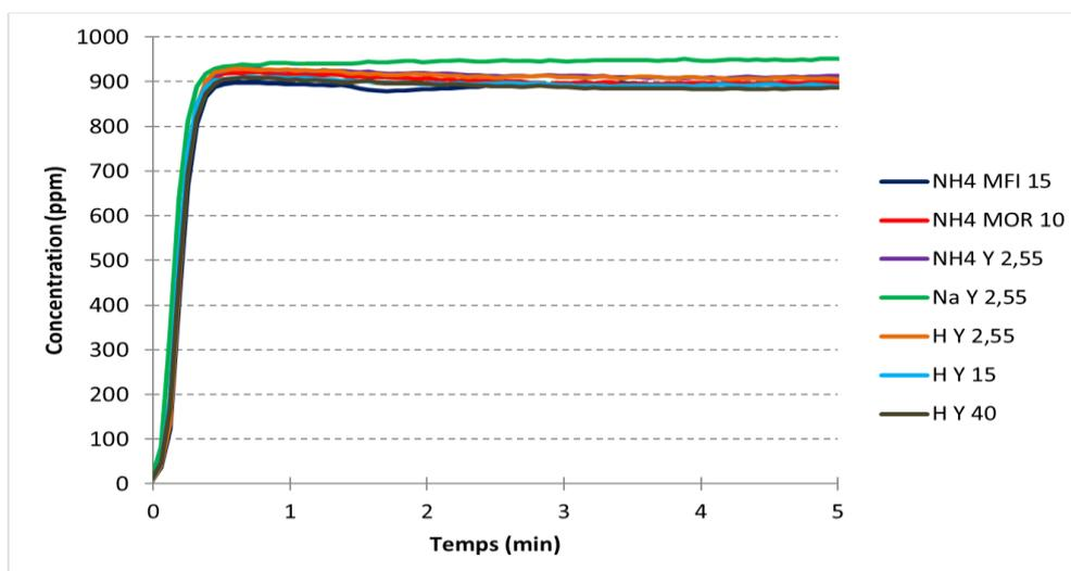
Graph 3.15 : Fronts de percée de CO au cours de l'adsorption à 30°C de 1000 ppm de CO et 8,5 % d'O<sub>2</sub> dilués dans N<sub>2</sub>
