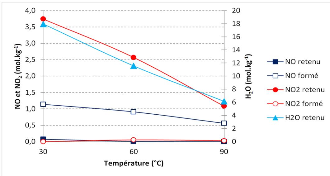
Graph 4.35 : Quantités à t = 900 min de NO, NO<sub>2</sub> et H<sub>2</sub>O retenues et/ou formées en fonction de la température lors de l'adsorption de 350 ppm de NO, 350 ppm de NO<sub>2</sub>, 8,5 % d'O<sub>2</sub> et 1 % de vapeur d'eau dilués dans N<sub>2</sub> sur la zéolithe Na Y 2,55 séchée
