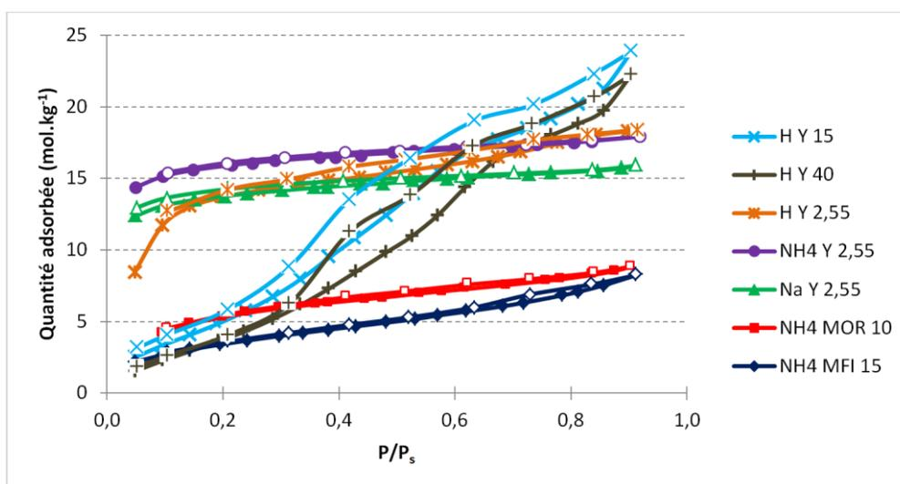
Graphe 3.12 : Isothermes d'adsorption de H<sub>2</sub>O à 20°C
