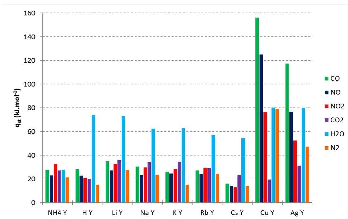
Graphe 5.1 : Chaleurs isostériques d'adsorption de CO, NO, NO<sub>2</sub>, CO<sub>2</sub>, H<sub>2</sub>O et N<sub>2</sub> déterminées à partir de la méthode DFT PBE TS/Hi à 50°C pour différentes faujasites Y de rapport Si/Al = 47
