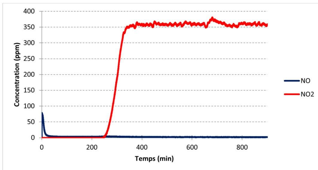
Graph 4.7 : Concentrations de sortie de NO et NO<sub>2</sub> au cours de l'adsorption à 30°C de 350 ppm de NO<sub>2</sub> dilués dans N<sub>2</sub> sur la zéolithe Na Y 2,55 séchée
