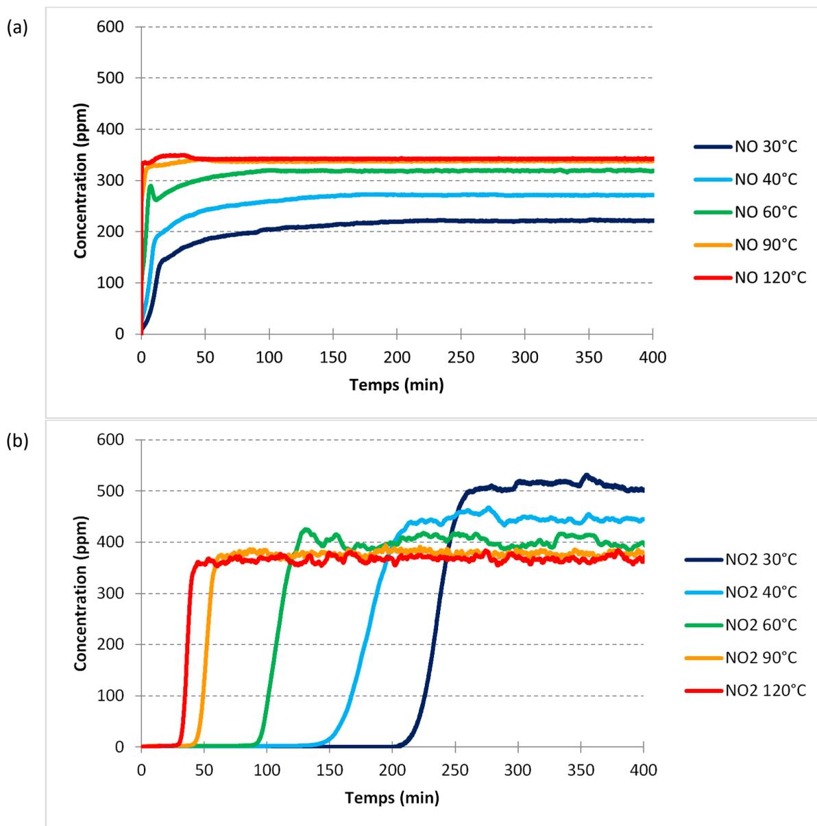
Graphe 4.26 : Concentrations de sortie de NO (a) et NO<sub>2</sub> (b) au cours de l'adsorption à différentes températures de 350 ppm de NO, 350 ppm de NO<sub>2</sub> et 8,5 % d'O<sub>2</sub> dilués dans N<sub>2</sub> sur la zéolithe Na Y 2,55 séchée
