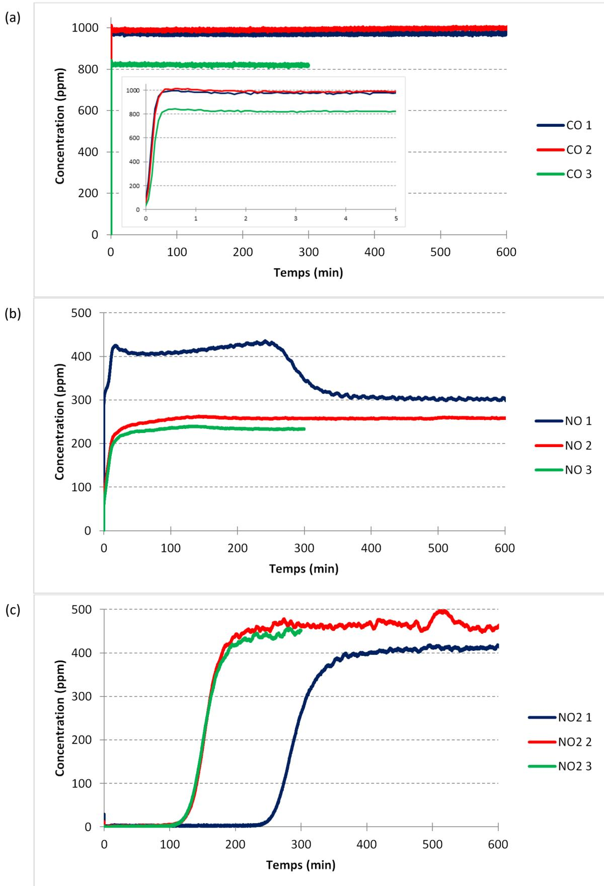
Graphe 4.1 : Fronts de percée au cours de l'adsorption à 30°C de 350 ppm de NO, 350 ppm de NO<sub>2</sub>, 1000 ppm de CO et 8,5 % d'O<sub>2</sub> dilués dans N<sub>2</sub> sur la zéolithe Na Y 2,55 : CO (a), NO (b) et NO<sub>2</sub> (c)
