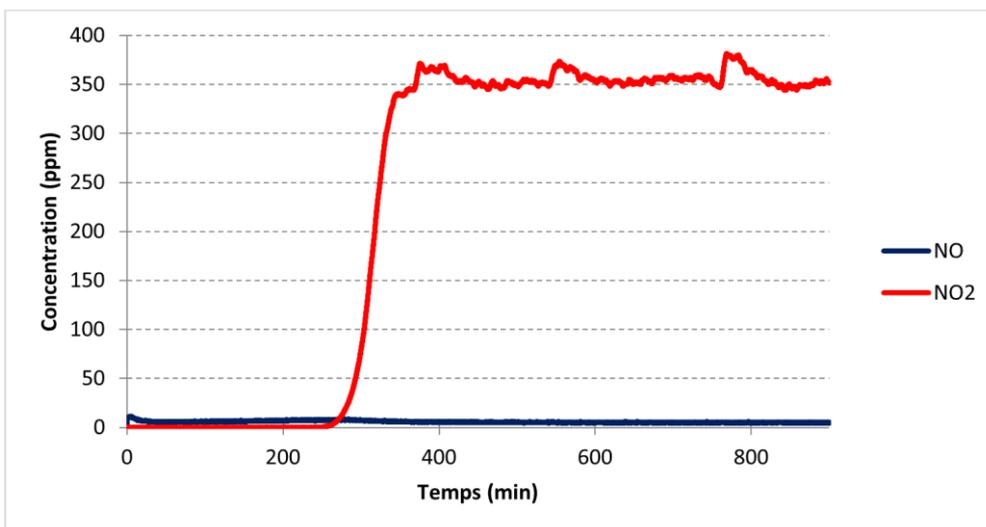
Graph 4.8 : Concentrations de sortie de NO et NO<sub>2</sub> au cours de l’adsorption à 30°C de 350 ppm de NO<sub>2</sub> et 8,5 % d’O<sub>2</sub> dilués dans N<sub>2</sub> sur la zéolithe Na Y 2,55 séchée
