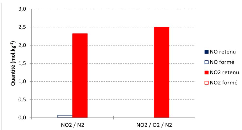
Graph 4.9 : Quantités retenues et formées à t = 900 min de NO et NO<sub>2</sub> en fonction de la présence de 8,5 % d’O<sub>2</sub> lors de l’adsorption à 30°C de 350 ppm de NO<sub>2</sub> dilués dans N<sub>2</sub> sur la zéolithe Na Y 2,55 séchée
