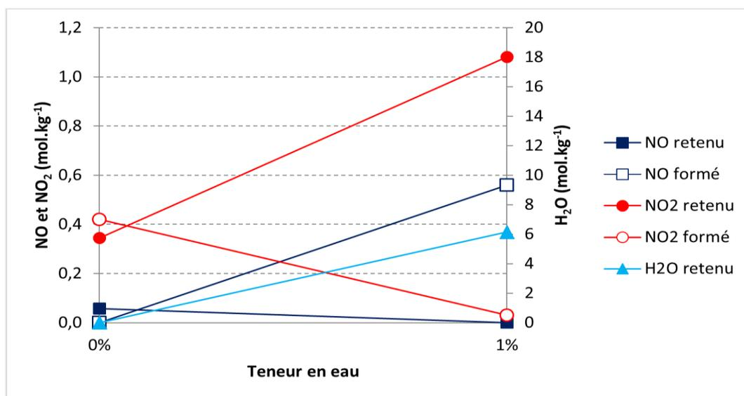
Graph 4.33 : Quantités à  $t = 900$  min de NO, NO<sub>2</sub> et H<sub>2</sub>O retenues et/ou formées en fonction de la teneur en eau lors de l'adsorption à 90°C de 350 ppm de NO, 350 ppm de NO<sub>2</sub> et 8,5 % d'O<sub>2</sub> dilués dans N<sub>2</sub> sur la zéolithe Na Y 2,55 séchée
