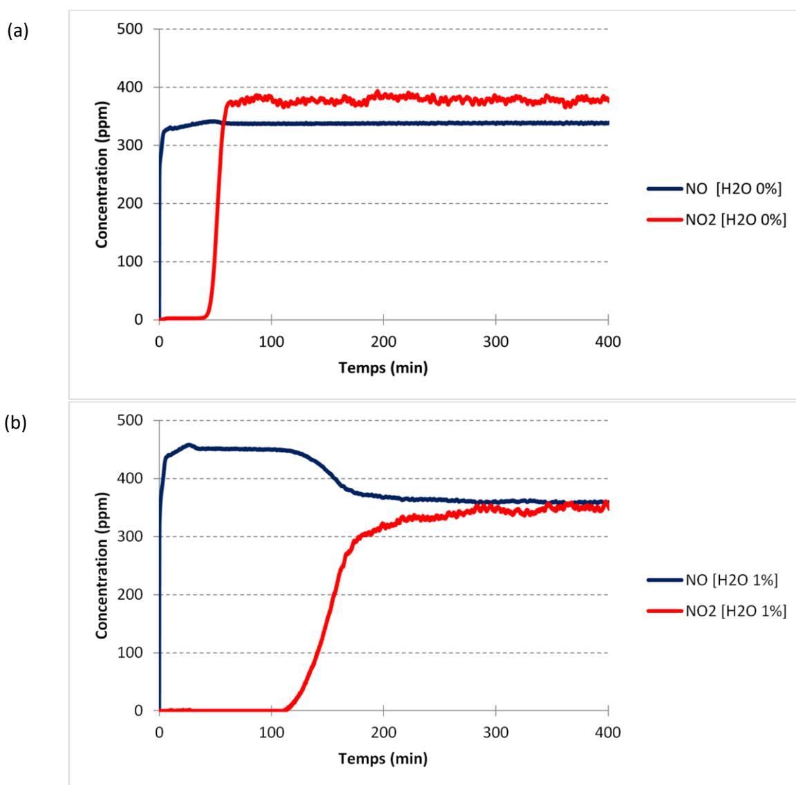
Graphe 4.31 : Concentrations de sortie de NO, NO<sub>2</sub> et H<sub>2</sub>O au cours de l'adsorption à 90°C de 350 ppm de NO, 350 ppm de NO<sub>2</sub> et 8,5 % d'O<sub>2</sub> dilués dans N<sub>2</sub> sur la zéolithe Na Y 2,55 séchée avec 0 % (a) et 1 % (b) de vapeur d'eau dans le mélange gazeux
