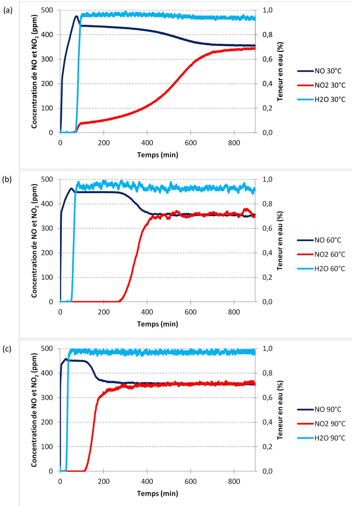
Graph 4.34 : Concentrations de sortie de NO, NO<sub>2</sub> et H<sub>2</sub>O au cours de l'adsorption à 30°C (a), 60°C (b) et 90°C (c) de 350 ppm de NO, 350 ppm de NO<sub>2</sub>, 8,5 % d'O<sub>2</sub> et 1 % de H<sub>2</sub>O dilués dans N<sub>2</sub> sur la zéolithe Na Y 2,55 séchée
