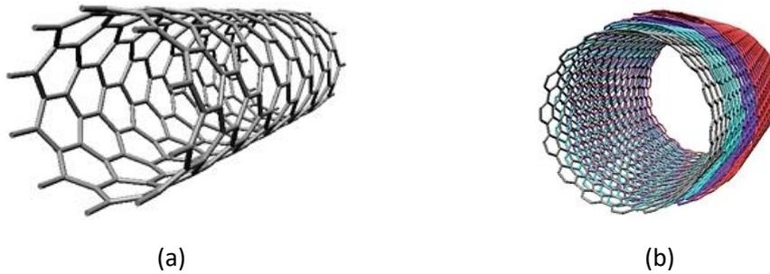
Figure 1.10 : Nanotubes mono-paroi (a) et multi-parois (b) [77]
