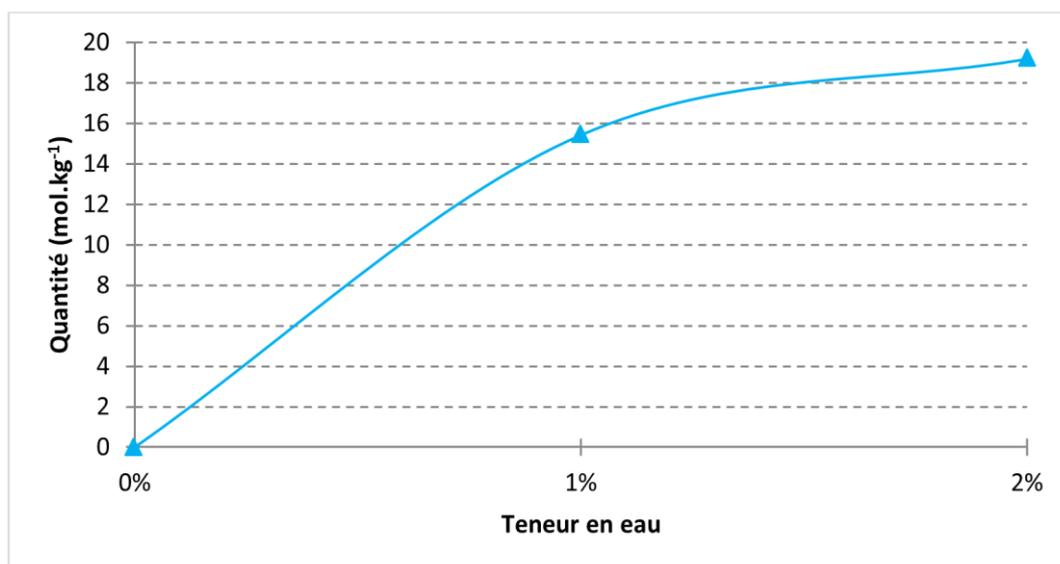
Graph 4.21 : Quantités de H<sub>2</sub>O retenues à l'équilibre en fonction de sa teneur dans le gaz vecteur N<sub>2</sub> sur la zéolithe Na Y 2,55 séchée
