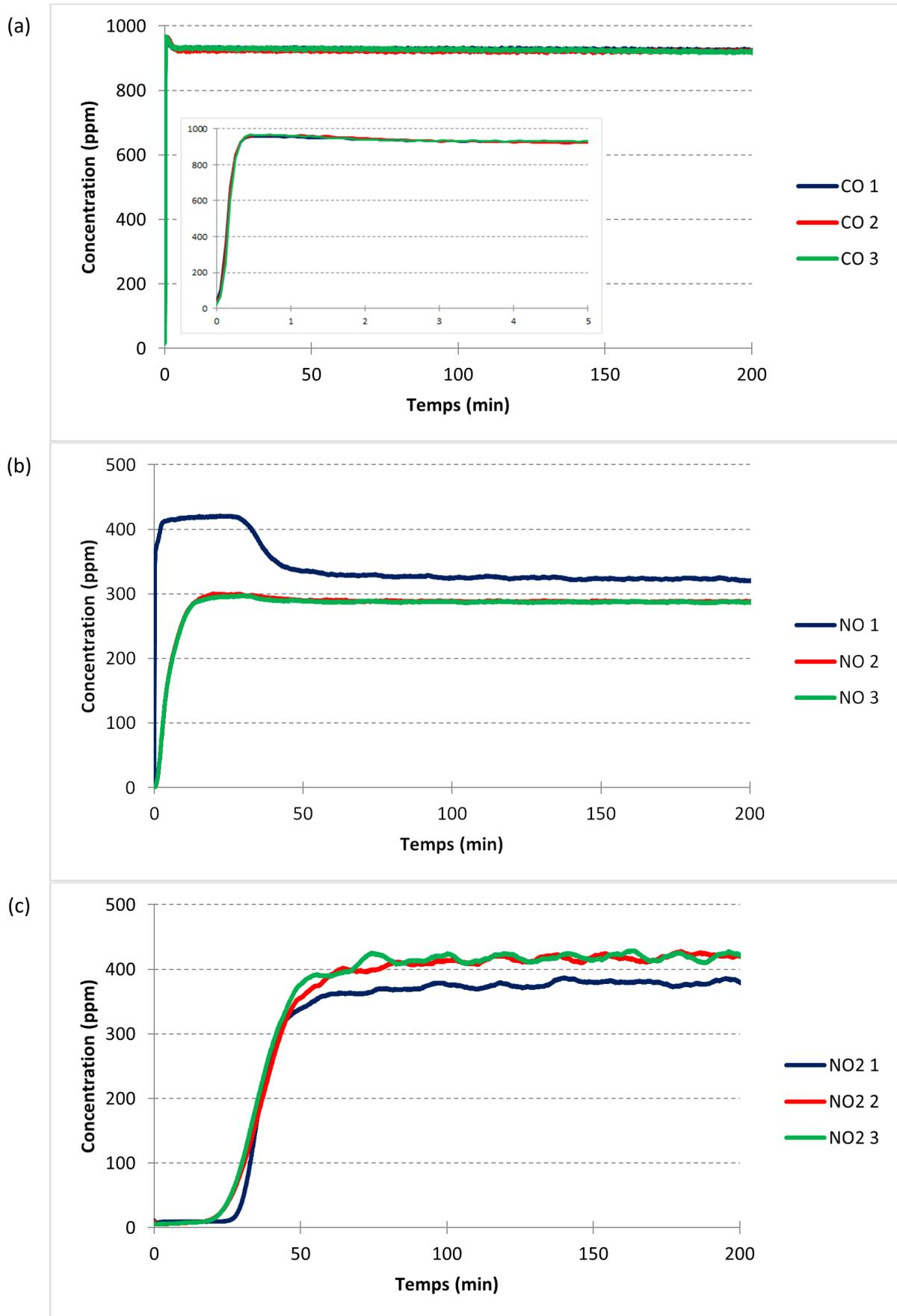
Graph 4.4 : Fronts de percée au cours de l'adsorption à 30°C de 350 ppm de NO, 350 ppm de NO<sub>2</sub>, 1000 ppm de CO et 8,5 % d'O<sub>2</sub> dilués dans N<sub>2</sub> sur la zéolithe H Y 2,55 : CO (a), NO (b) et NO<sub>2</sub> (c)
