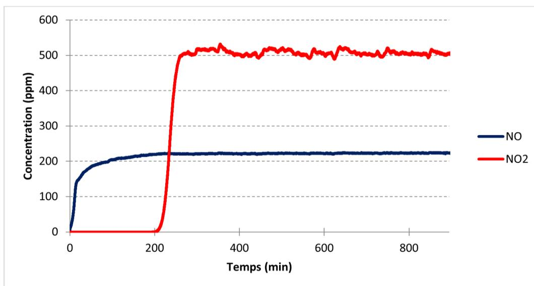
Graphe 4.11 : Concentrations de sortie de NO et NO<sub>2</sub> au cours de l'adsorption à 30°C de 350 ppm de NO, 350 ppm de NO<sub>2</sub> et 8,5 % d'O<sub>2</sub> dilués dans N<sub>2</sub> sur la zéolithe Na Y 2,55 séchée
