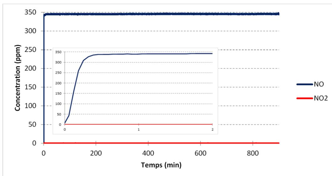
Graph 4.5 : Concentrations de sortie de NO et NO<sub>2</sub> au cours de l'adsorption à 30°C de 350 ppm de NO dilués dans N<sub>2</sub> sur la zéolithe Na Y 2,55 séchée – le graphe intérieur est un zoom sur les deux premières minutes
