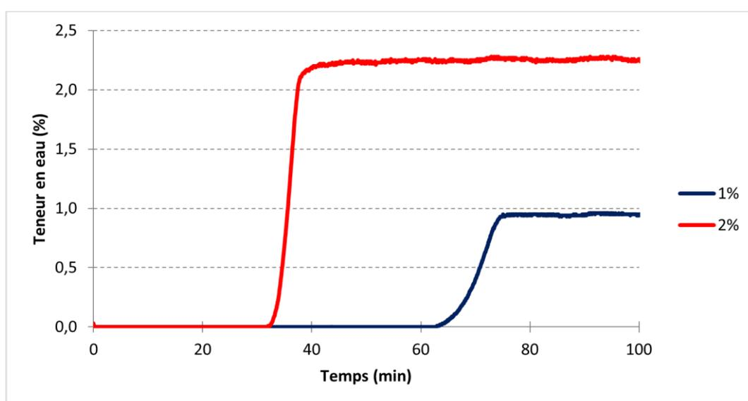
Graph 4.20 : Concentrations de sortie de H<sub>2</sub>O au cours de son adsorption avec N<sub>2</sub> à 30°C sur la zéolithe Na Y 2,55 séchée
