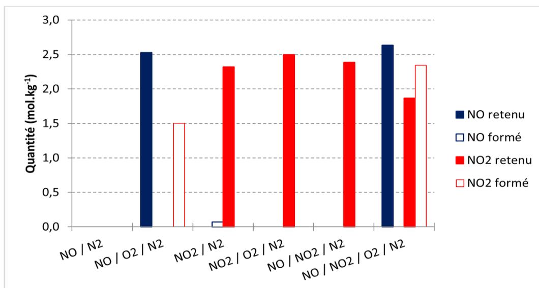
Graph 4.13 : Quantités de NO et NO<sub>2</sub> retenues et formées au cours des expériences d'adsorption de NO, NO<sub>2</sub> et du mélange NO / NO<sub>2</sub> à 30°C sur la zéolithe Na Y séchée
