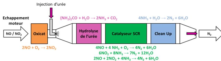
Figure 1.1 : Fonctionnement du système SCR [30]
