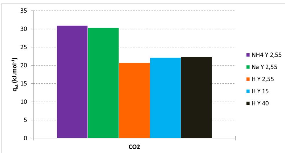
Graphe 3.10 : Chaleurs isostériques d'adsorption de CO<sub>2</sub> déterminées à partir de la relation de Clausius-Clapeyron
