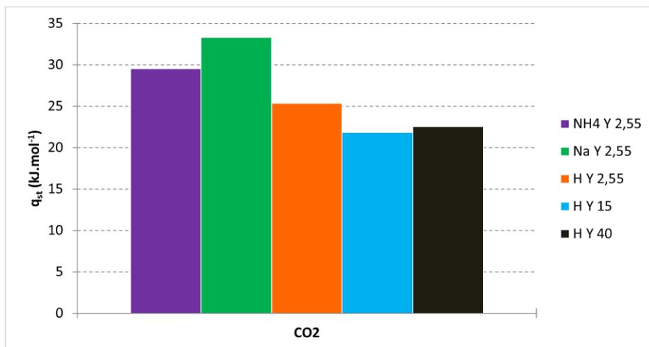
Graphe 3.8 : Chaleurs isostériques d'adsorption de CO<sub>2</sub> déterminées à 50°C à partir du modèle de Langmuir
