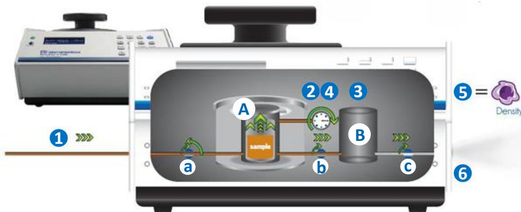
Figure 2.2 : Fonctionnement du pycnomètre AccuPyc 1330 (Micromeritics) [105]
