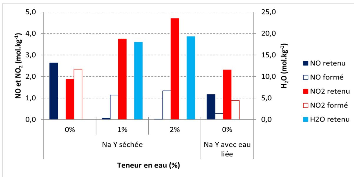
Graphe 4.25 : Quantités à  $t = 900$  min de  $\text{NO}$ ,  $\text{NO}_2$  et  $\text{H}_2\text{O}$  retenues et/ou formées en fonction de la teneur en eau lors de l'adsorption à  $30^\circ\text{C}$  de  $350$  ppm de  $\text{NO}$ ,  $350$  ppm de  $\text{NO}_2$  et  $8,5\%$  d' $\text{O}_2$  dilués dans  $\text{N}_2$  sur la zéolithe Na Y 2,55 séchée ou contenant de l'eau liée
