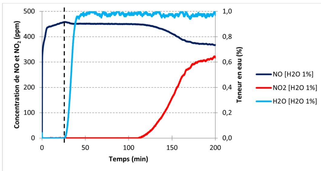
Graphe 4.32 : Concentrations de sortie de NO, NO<sub>2</sub> et H<sub>2</sub>O au cours de l'adsorption à 90°C de 350 ppm de NO, 350 ppm de NO<sub>2</sub> et 8,5 % d'O<sub>2</sub> dilués dans N<sub>2</sub> sur la zéolithe Na Y 2,55 séchée avec 1 % de vapeur d'eau dans le mélange gazeux – zoom du graphe 4.31(b)
