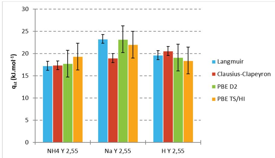
Graph 3.6 : Comparaison des chaleurs isostériques d'adsorption de N<sub>2</sub> à 50°C obtenues expérimentalement ou par DFT
