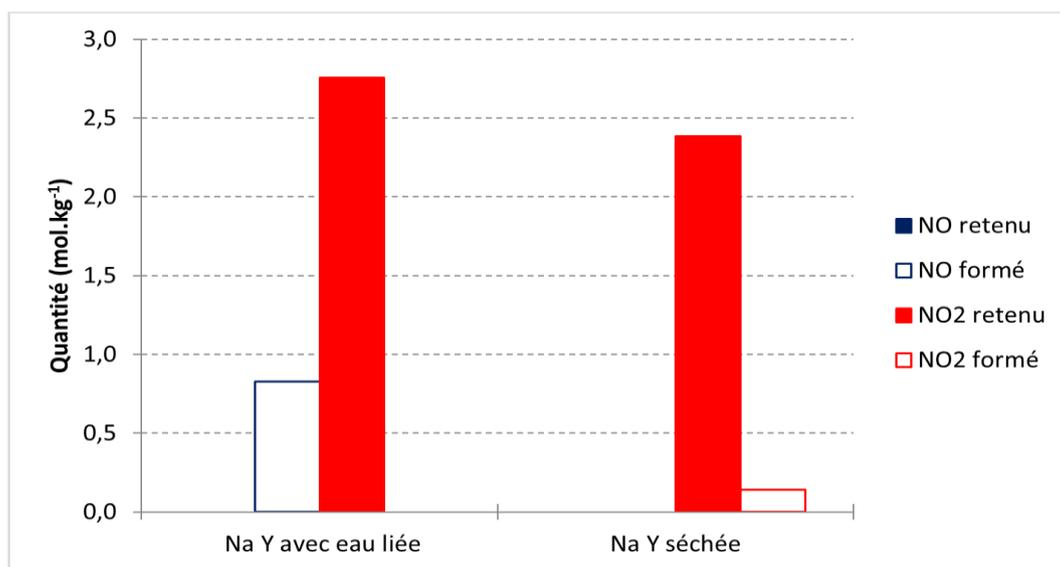
Graphe 4.18 : Quantités retenues et formées à  $t = 900 \text{ min}$  de NO et  $\text{NO}_2$  en fonction de la présence d'eau liée dans la zéolithe Na Y 2,55 lors de l'adsorption à  $30^\circ\text{C}$  de 350 ppm de NO et 350 ppm de  $\text{NO}_2$  dilués dans  $\text{N}_2$
