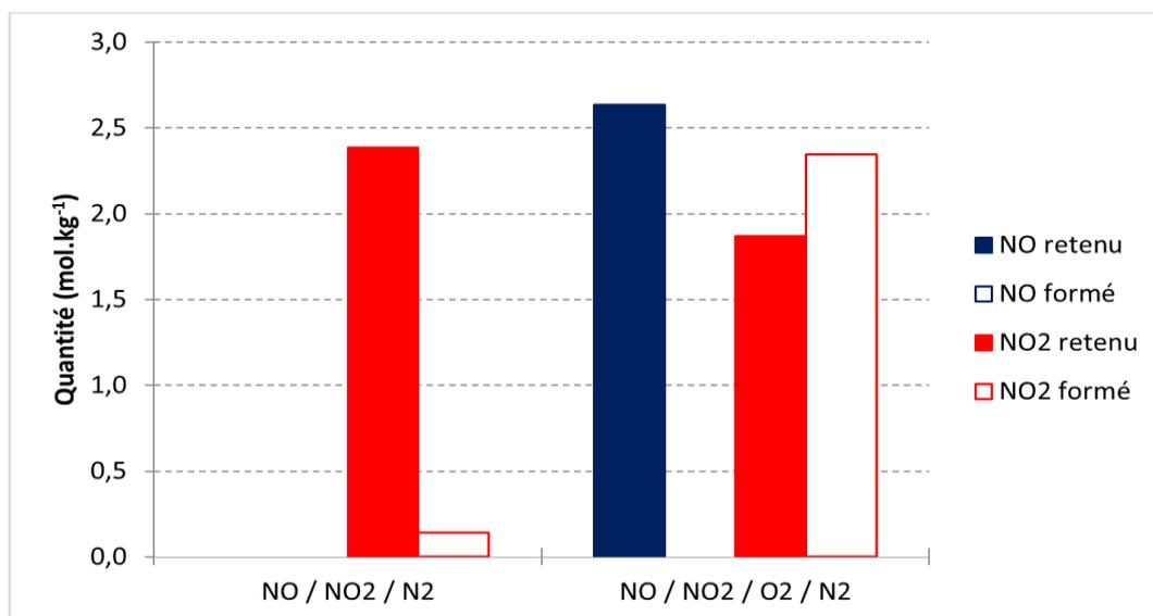
Graphe 4.12 : Quantités retenues et formées à  $t = 900$  min de NO et NO<sub>2</sub> en fonction de la présence de 8,5 % d'O<sub>2</sub> lors de l'adsorption à 30°C de 350 ppm de NO et 350 ppm de NO<sub>2</sub> dilués dans N<sub>2</sub> sur la zéolithe Na Y 2,55 séchée
