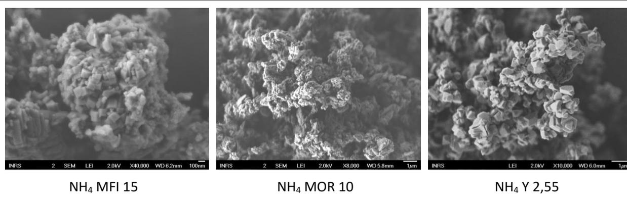
La forme des grains de zéolithes après leur mise en forme a également été analysée. A l'instar du grain de zéolithe Na Y 2,55 de la figure 3.1, les images obtenues montrent que les grains formés ne présentent pas de fissures. La poudre semble donc être suffisamment compressée.
