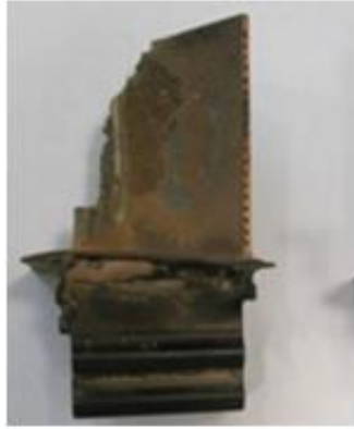
Figure 1-7 : Aube de turbine HP ayant fondu du fait du bouchage des trous de refroidissement [Duf17]
