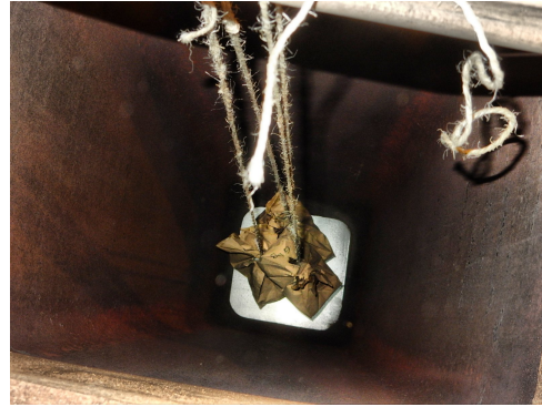
(b) Même lingotière que 2.8a avec sac d'inoculants suspendus
