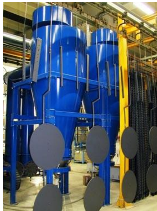
Figure 2.1 : Dépoussiéreur mécanique : cyclone ("Cyclone (séparation)," 2015, "Épuration Dépoussiéreurs Cyclone avec tamisage," 2015)
