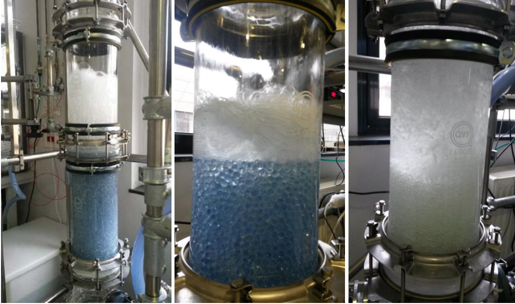
Figure 4.1 : Engorgement de la colonne en configuration contre-courant (de gauche à droite : 50 cm de billes de 5 mm, 20 cm de billes de 10 mm et 20 cm d'anneaux Raschig)
