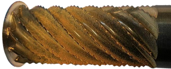
Figure III. 22. Accumulation des copeaux en poudre sur l'outil de coupe combiné CZ10.
