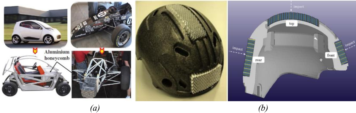
Figure I. 3. Absorbeurs d'énergie d'impact en nid d'abeilles : (a) Automobile, [6] ; (b) casque motocycliste, [7].
