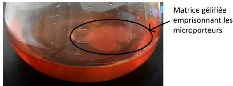
Figure 5.3: Formation de matrice gélifiée piégeant les microporteurs lors d'une culture dynamique à t_0 + 1 jour.
