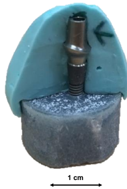
Figure II-1 Repositionnement du pilier dans l'implant grâce à la clé
