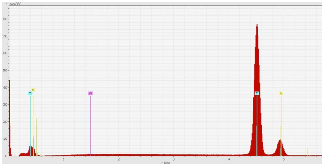
Figure III-3 Spectre EDS obtenu sur échantillon de titane pur
