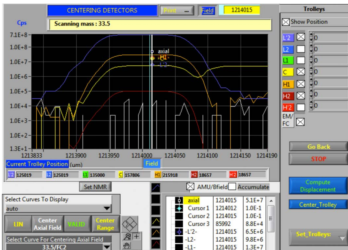
Figure II-13 : Fenêtre de centrage des chariots du système de détection lors de la session de février 2016 (2016-II), montrant le centrage des sommets de pics pour les quatre isotopes du soufre, soit le ^{32}\text{S} (en bleu), le ^{33}\text{S} (en jaune), le ^{34}\text{S} (en orange) et le ^{36}\text{S} (en rouge). Tous les pics sont bien définis, avec des sommets plats et la résolution de masse (RMP ~6000) permet de bien distinguer le pic du ^{33}\text{S} (à gauche) de celui du ^{32}\text{SH} (à droite).
