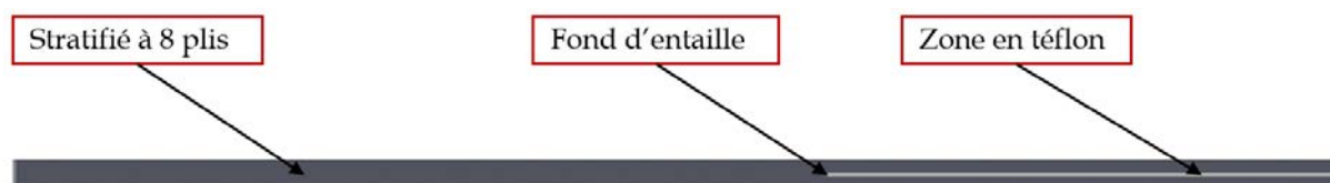
Figure 2-18 : Schéma illustratif du composite pour les essais en mode I et mode II
