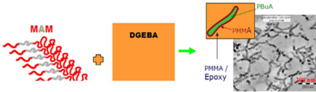
Figure 1-17 : Structure d'un DGEBA renforcé par des copolymères tri-blocs type MAM [2]
