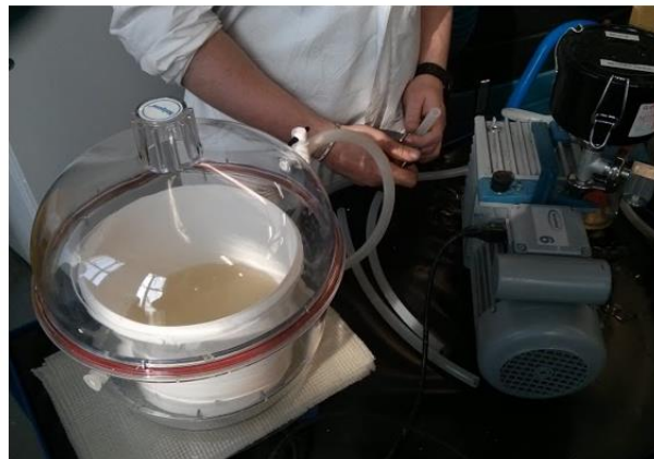
(b) Dégazage de la résine avant infusion
