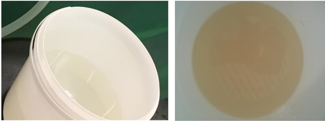
(a) Résine acrylique pure (à gauche) et chargée à 15% de Nanostrength (à droite)
