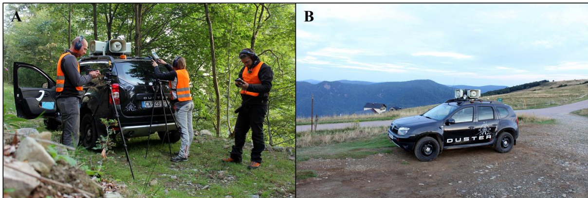
Figure 6 : Émission du son synthétique à l'aide de haut-parleurs et prises de mesures (point GPS, intensité sonore - A ) et dispositif d'émission sonore fixé au toit du véhicule de terrain ( B ) (© CROC 2015).
