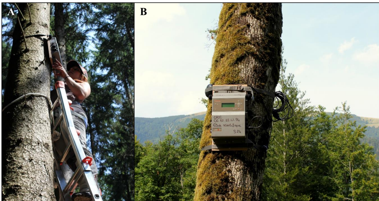
Figure 4 : Mise en place d'un enregistreur autonome de type SM3 (A) et enregistreur posé dans le Massif des Vosges (B) (© CROC 2015).
