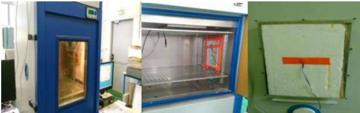
Figure 52: montage expérimental (chambre conditionnée avec des échantillons de taille 20X15 cm<sup>2</sup>)
