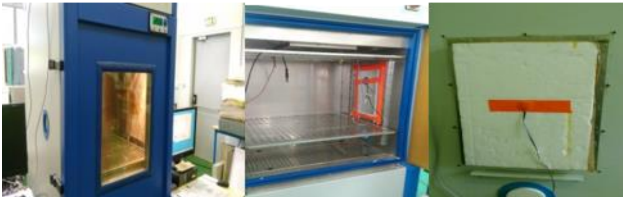
Figure 52: montage expérimental (chambre conditionnée avec des échantillons de taille 20X15 cm 2 )
