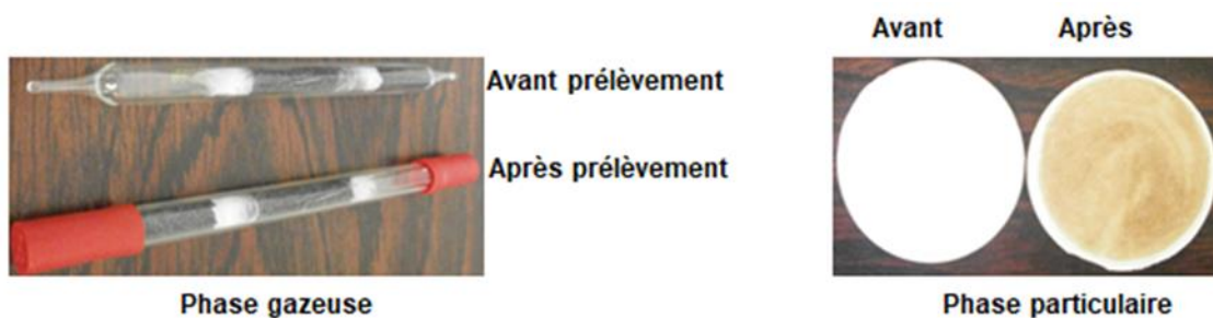
Figure 7 Dispositifs de prélèvement des fumées du courant principal de cigarette (MSS)
