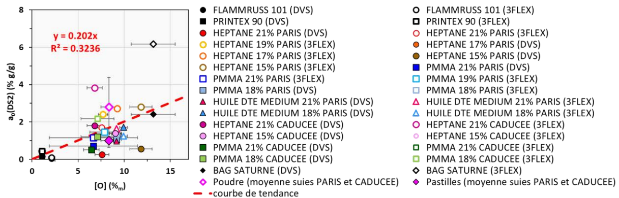
Figure C.3-4 : Evolution de la concentration en sites primaires d'adsorption, déterminée à l'aide du modèle D2, avec la teneur en oxygène
