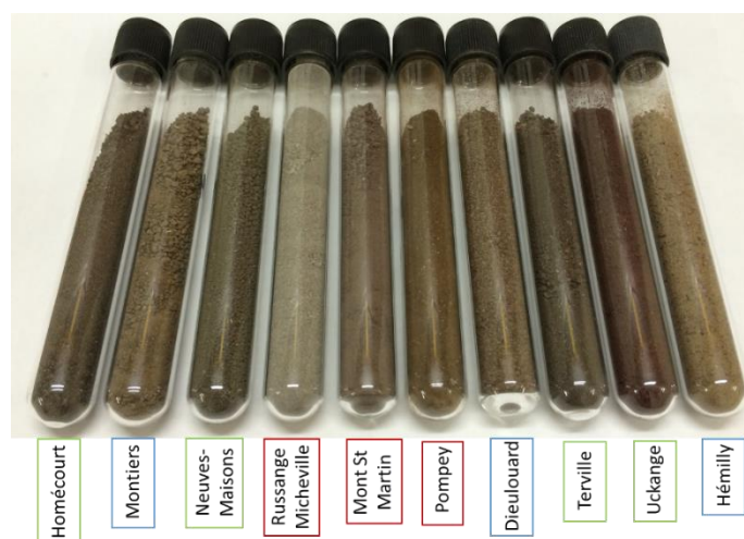
Figure 2.3. Aspect des 10 sols après séchage et tamisage à 2 mm.
