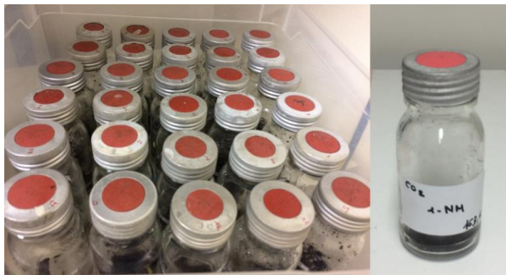
Figure 2.7. Illustration du dispositif utilisé pour les mesures de minéralisation.
