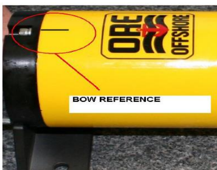
Figure 37 – Centrale inertielle horizontale avec son dispositif électronique
