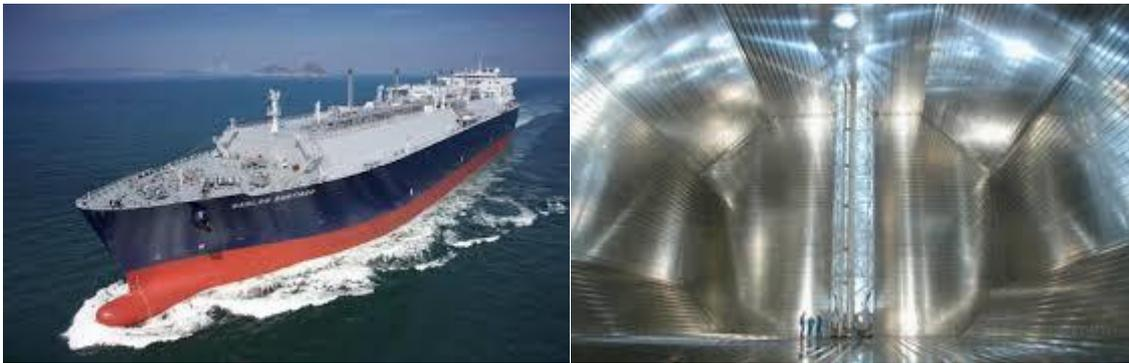
Figure 6 – Méthanier à membrane
