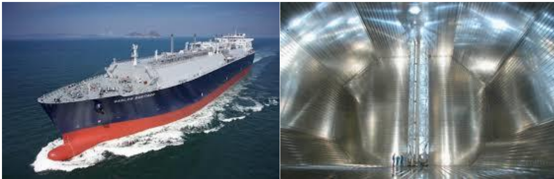
Figure 6 – Méthanier à membrane
