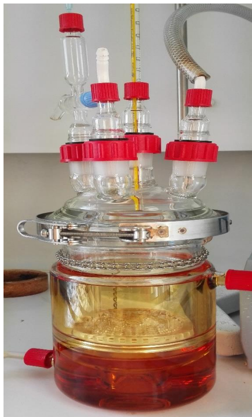
Figure 52: Image du réacteur de salinisation en phase gazeuse utilisé dans notre laboratoire.
