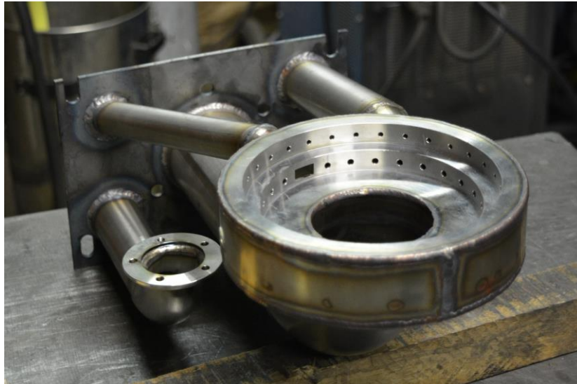
Figure 55 : Photo du brûleur à la fin de sa fabrication
