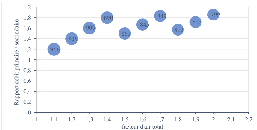
Figure 79 : Variation du rapport des débits d'air primaire/secondaire permettant d'atteindre la température de flamme maximale en fonction du facteur d'air total.
