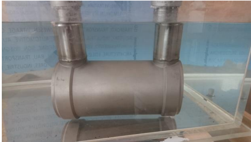
Figure 106 : échangeur de chaleur immergé dans l'eau avec injection d'air à 0,4MPa, Aucune trace de fuite visible.
