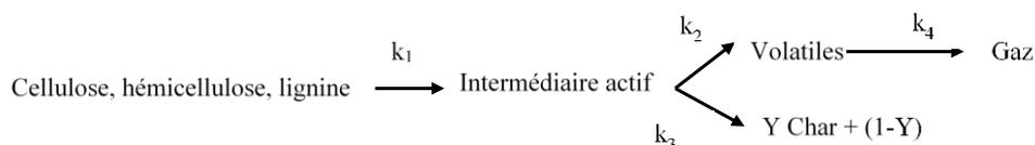
Figure 22 : Schéma réactionnel de Broido-Shafizadeh [64].
